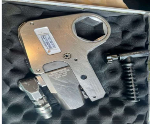
Figura 27 Llave hidráulica dañada
