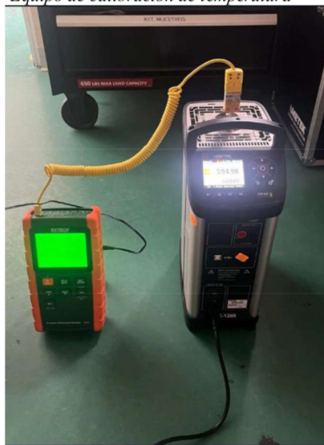
Figura 26 Equipo de calibración de temperatura
