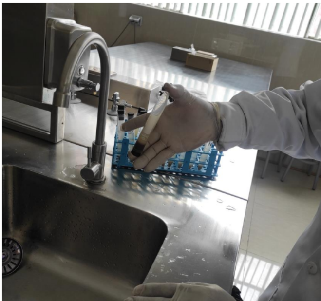
Figura 22. Se coloca un tapón al tubo y se mueve para tener una mezcla homogénea entre el sedimento y el sulfato de zinc.
