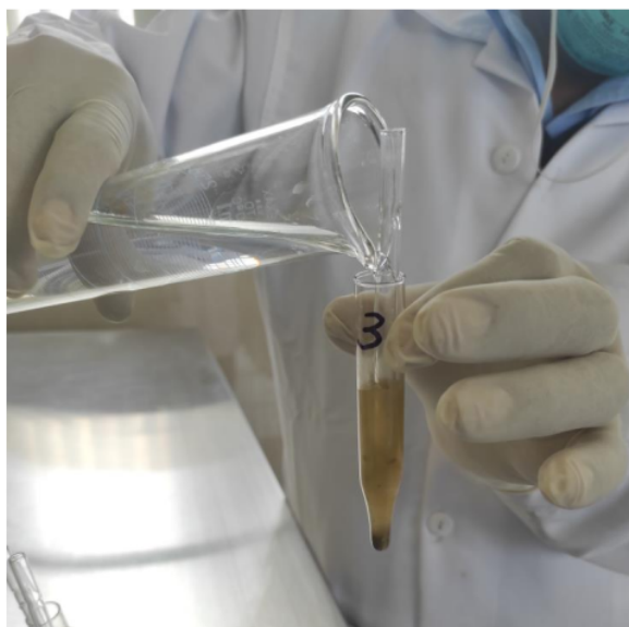
Figura 20. Se añade el sulfato de cinc a cada tubo de muestra y se enrasa este.
