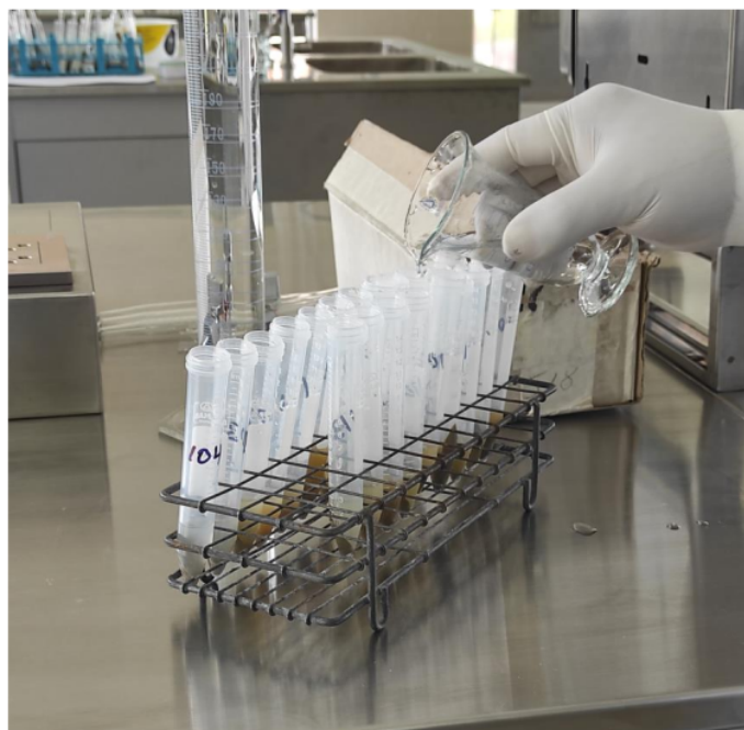
Figura 14. Se enraza cada tubo antes de poner a la centrifuga.
