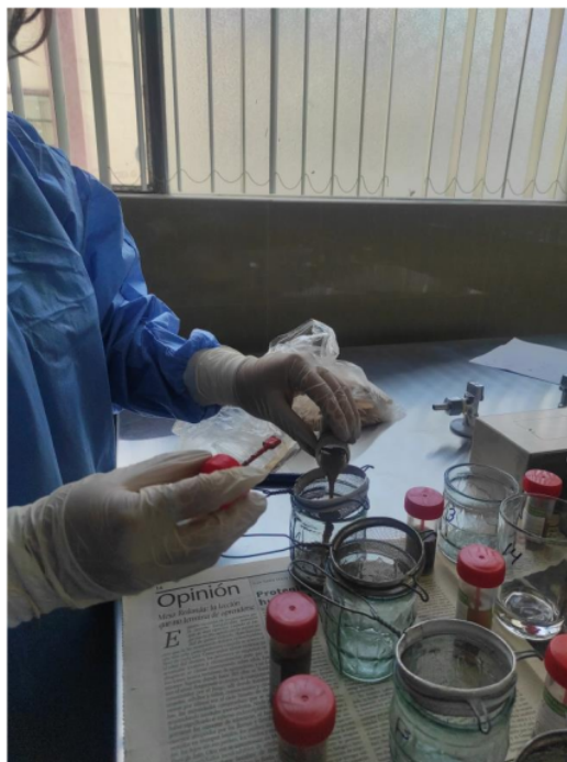
Figura 11. Se procede a tamizar una fracción de la muestra
