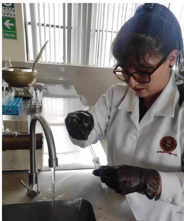
Figura 18. Se elimina con una pipeta Pasteur el exceso de sedimento, pero sin tocar el fondo
