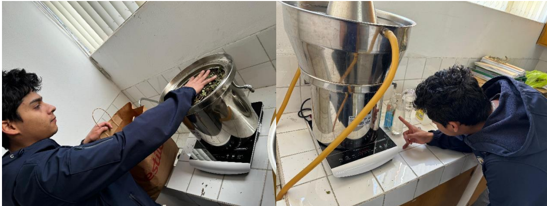
Anexo N°6: Obtención del aceite esencial de Minthostachys mollis (muña)
