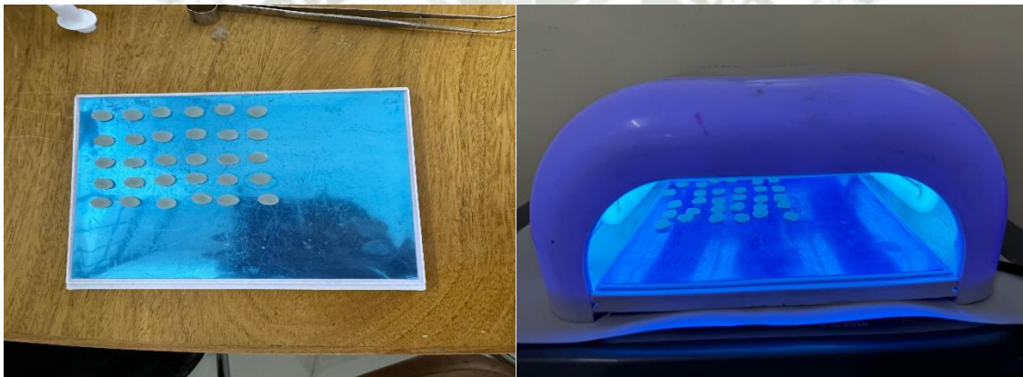
Anexo N°7: fotopolimerización de discos de resina
