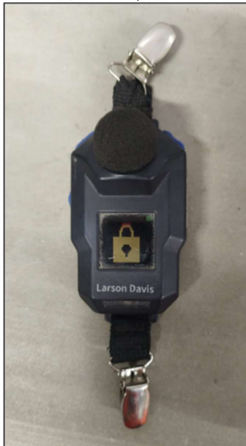
Figura 8. Dosímetro de ruido, modelo Spartan 730 marca Larson Davis
