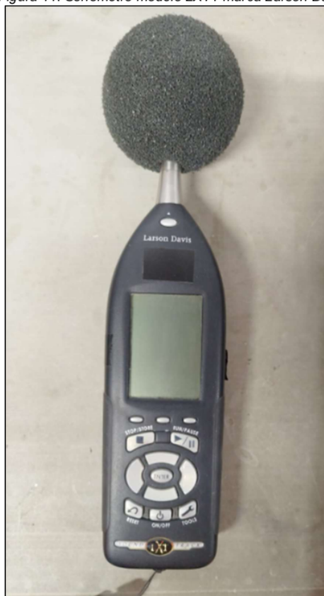
Figura 11. Sonómetro modelo LXT1 marca Larson Davis
