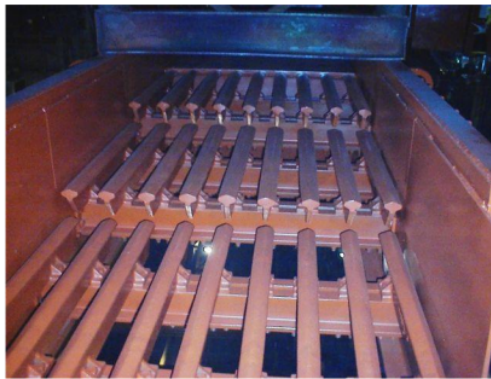
Figura 2.11 Alimentadores vibratorios grizzly Fuente: Tipos de alimentadores y sus aplicaciones | McLanahan
