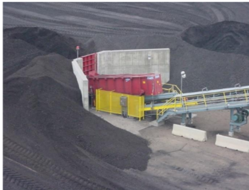
Figura 2.10 Alimentador de arrastre y recuperación
