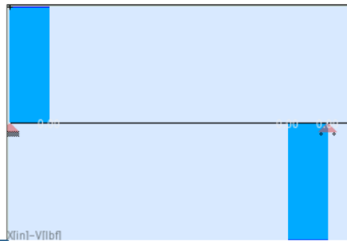
8 Figura 4.8 Diagrama de fuerzas cortantes en Y – X Fuente: Elaboración propia
