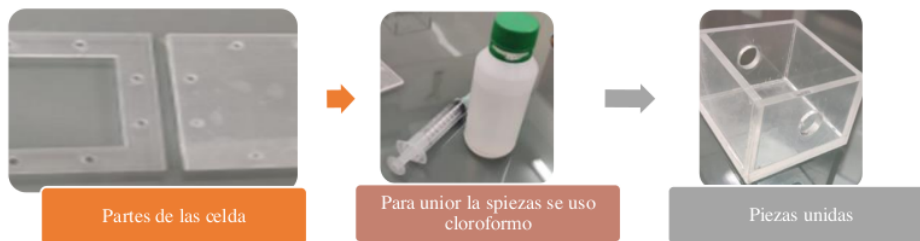
Figura 3.3. Construcción de la nueva celda
