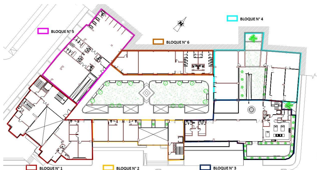
Gráfico N° 6.23: Esquema de bloques y juntas de separación Segunda planta.
