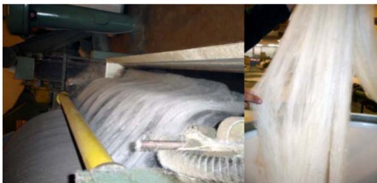
Figura 2.13 Proceso de cardado y fibra cardada
