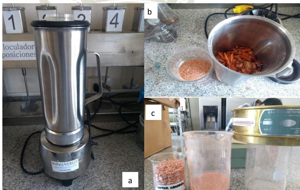
Figura 9. Licuadora para la tritución de los exoesqueletos (a y b), tamizaje de exoesqueletos de camarón (c).
