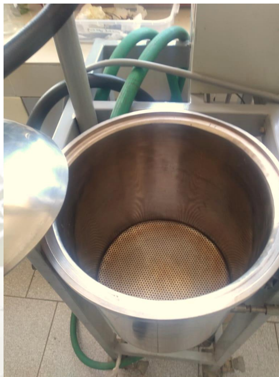
Figura 17. Contenedor hermético (muestra vegetal) del equipo de destilación por arrastre de vapor de agua escala laboratorio.
