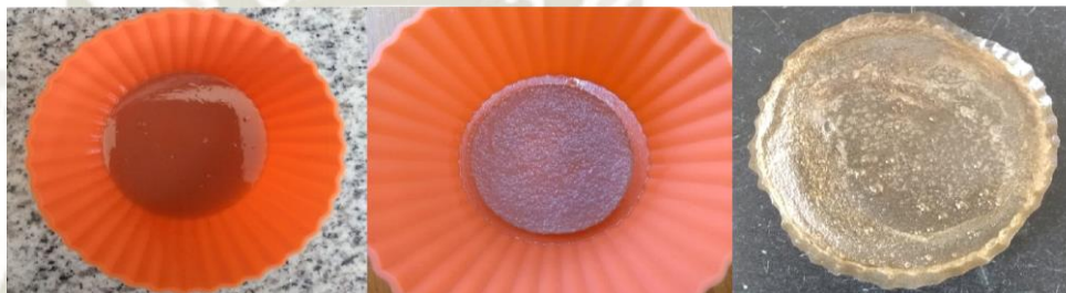
Figura 31. Solución de biopelícula fresca a las 0 horas (a), solución de biopelícula pasada las 12 horas a temperatura ambiente (b), solución de biopelícula pasada las 24 horas a temperatura ambiente (c).
