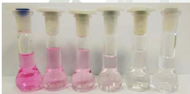
Figura 27. Medición de la absorbancia de la cinética del teñido.
