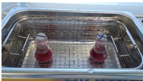
Figura 26. Teñido asistido con ultrasonido de fibra de alpaca.
