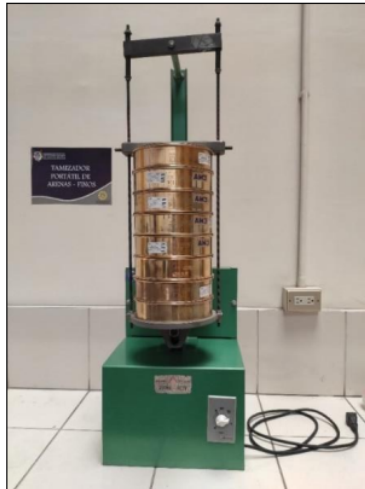
Figura 6 Ensayo de granulometría
