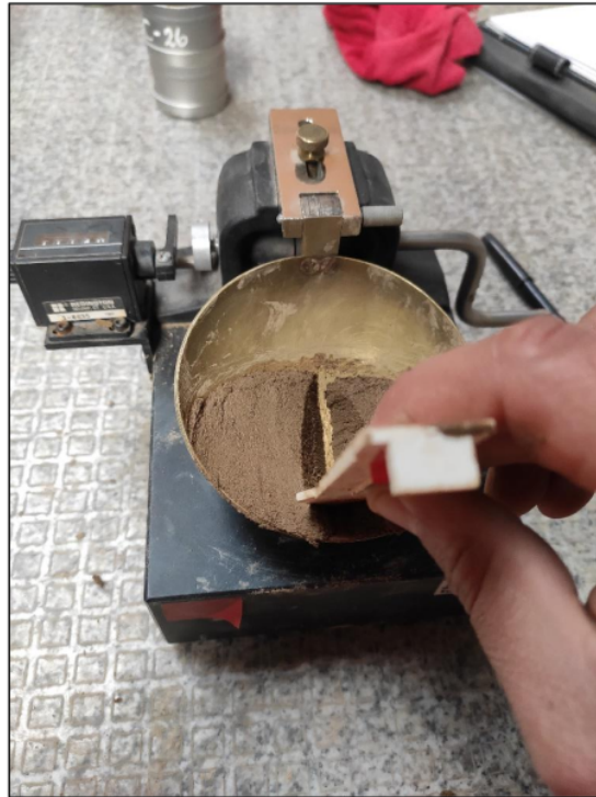
Imagen 9 Ensayo de limite liquido
