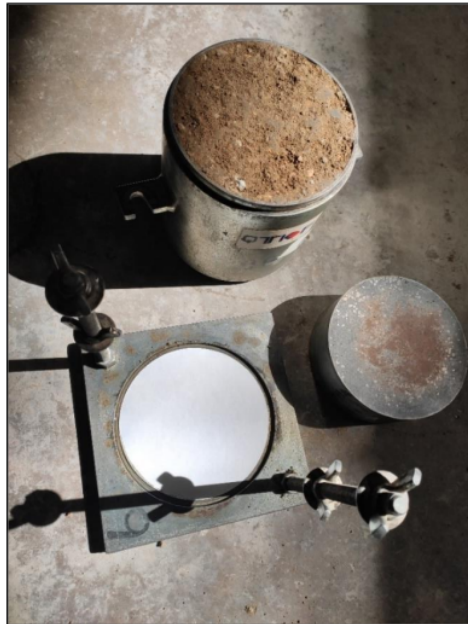
Imagen 18 Ensayo de cbr - afirmado
