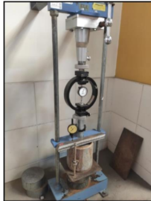
Figura 19 Ensayo de Penetración de CBR
