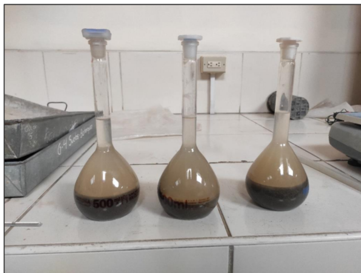
Imagen 13 Ensayo de gravedad especifica del agregado fino
