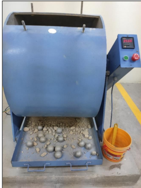
Imagen 11 Ensayo de abrasión de los ángeles
