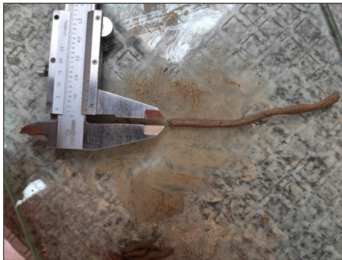
Imagen 10 Ensayo de limite plástico
