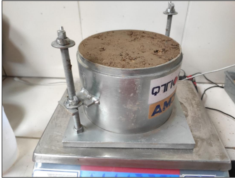
Imagen 17 Ensayo de Proctor modificado para cbr
