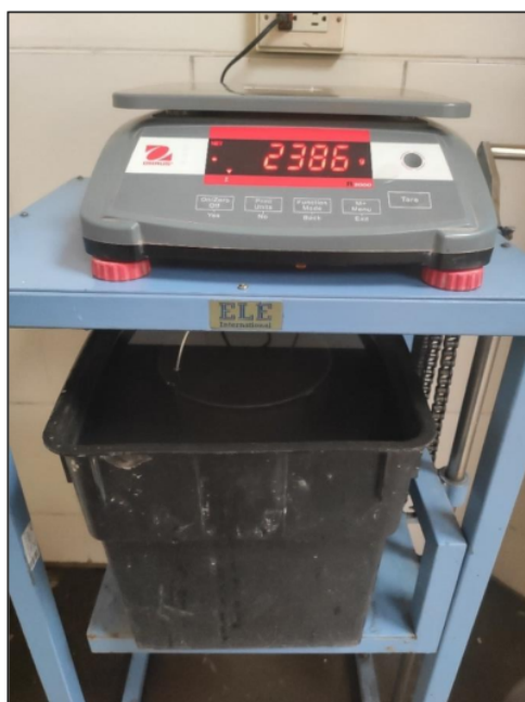
Imagen 14 Ensayo de gravedad especifica del agregado grueso
