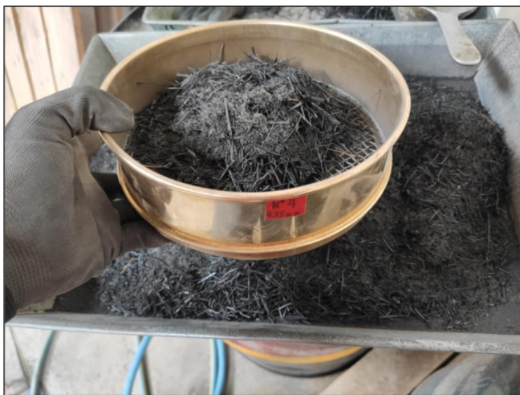
Imagen 26 Tamizado de la ceniza para ensayar (tamiz n°04)
