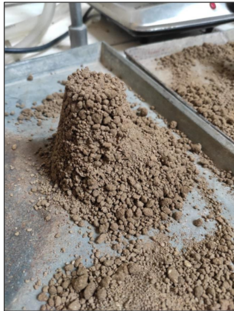
Imagen 12 Ensayo de gravedad específica del agregado fino
