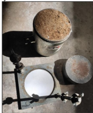
Figura 17 Ensayo de CBR
