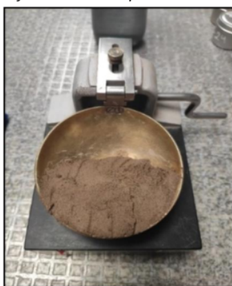
Figura 13 Ensayo de Limite Liquido
