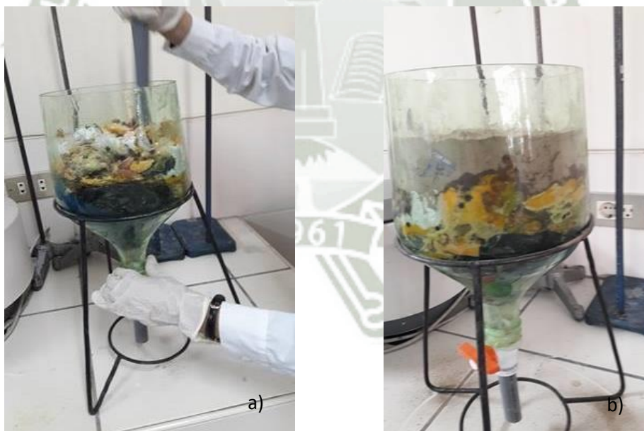
Figura 32: Llenado y compactación de los RR.SS.
