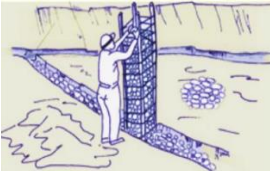
Figura 7: Drenaje de gases con chimeneas puntuales. (Jaramillo, 2002a).
