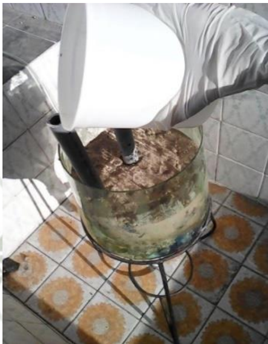
Figura 36: Recirculación de lixiviados
