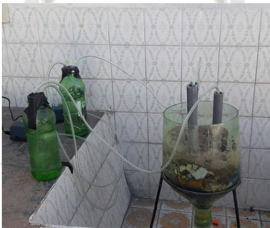
Figura 33: Inyección de aire en el lisímetro.
