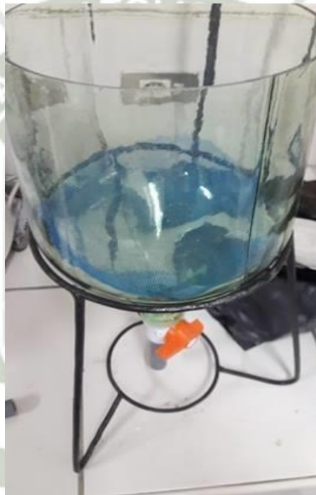
Figura 30: Estructura del Lisímetro
