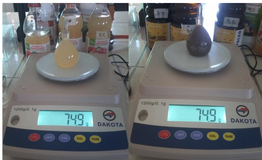
Figura N°9: Pesada del picnómetro más muestras
