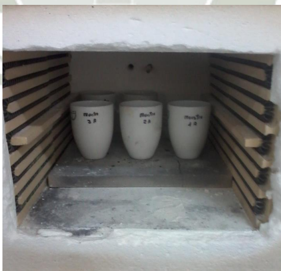
Figura N°1: Crisoles con muestras colocadas en la mufla
