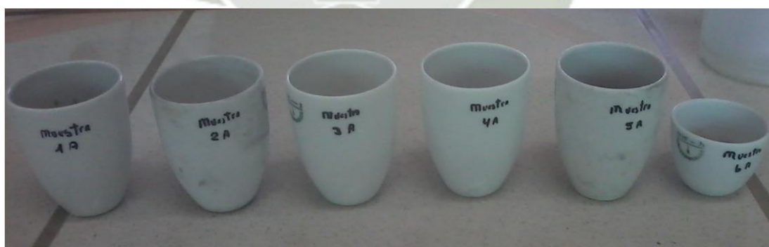
Figura N°6: Evaluación del porcentaje de cenizas
