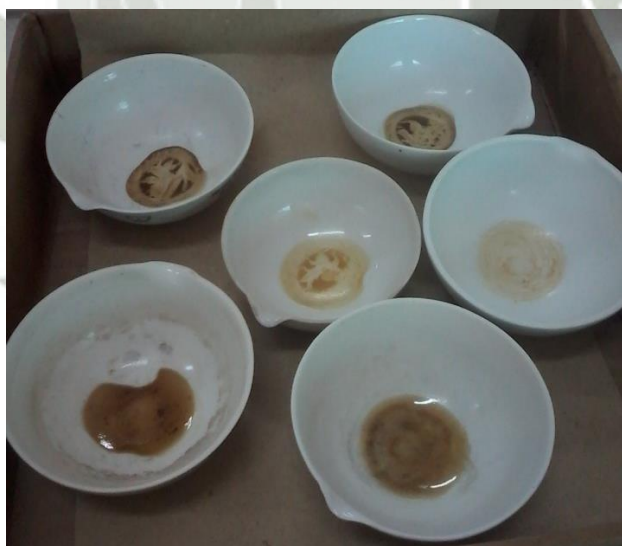
Figura N°2: Cápsulas de porcelana con muestra para la determinación de humedad
