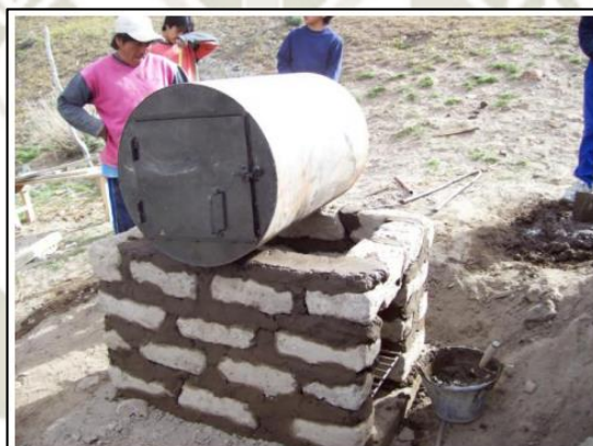
Figura 24: Tambor dentro del horno el cual se encargará de recibir la carga a secar.
