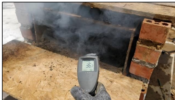
Figura 32: Medición de temperatura interior del horno.
