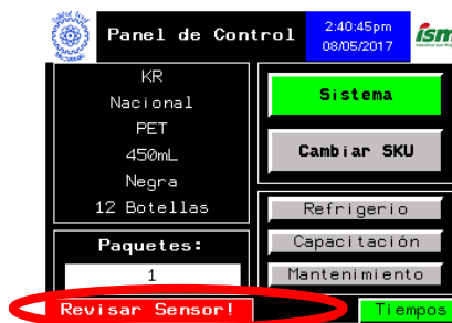
Figura 5.90. Mensaje de alarma del estado del sensor
