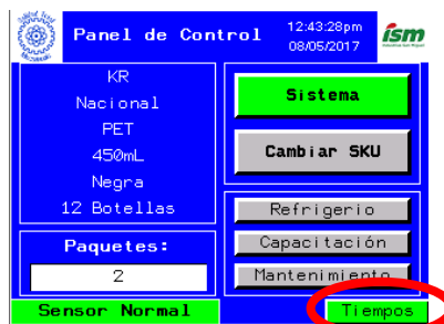
Figura 5.76. Panel de control después de seleccionar el tipo de parada
