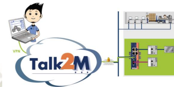
Figura 4.45. Principio de funcionamiento eWON Cosy
