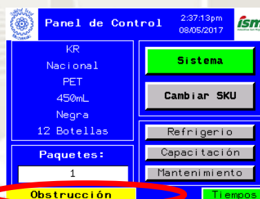
Figura 5.89. Advertencia de obstrucción del sensor
