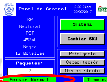
Figura 5.88. Piloto que muestra el estado del sensor: normal
