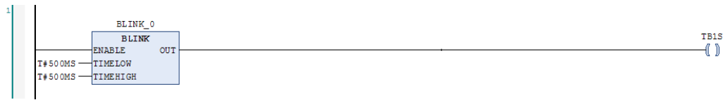
Figura 5.5. Rung 1 – POU Generador TB – Programa PLC M251
