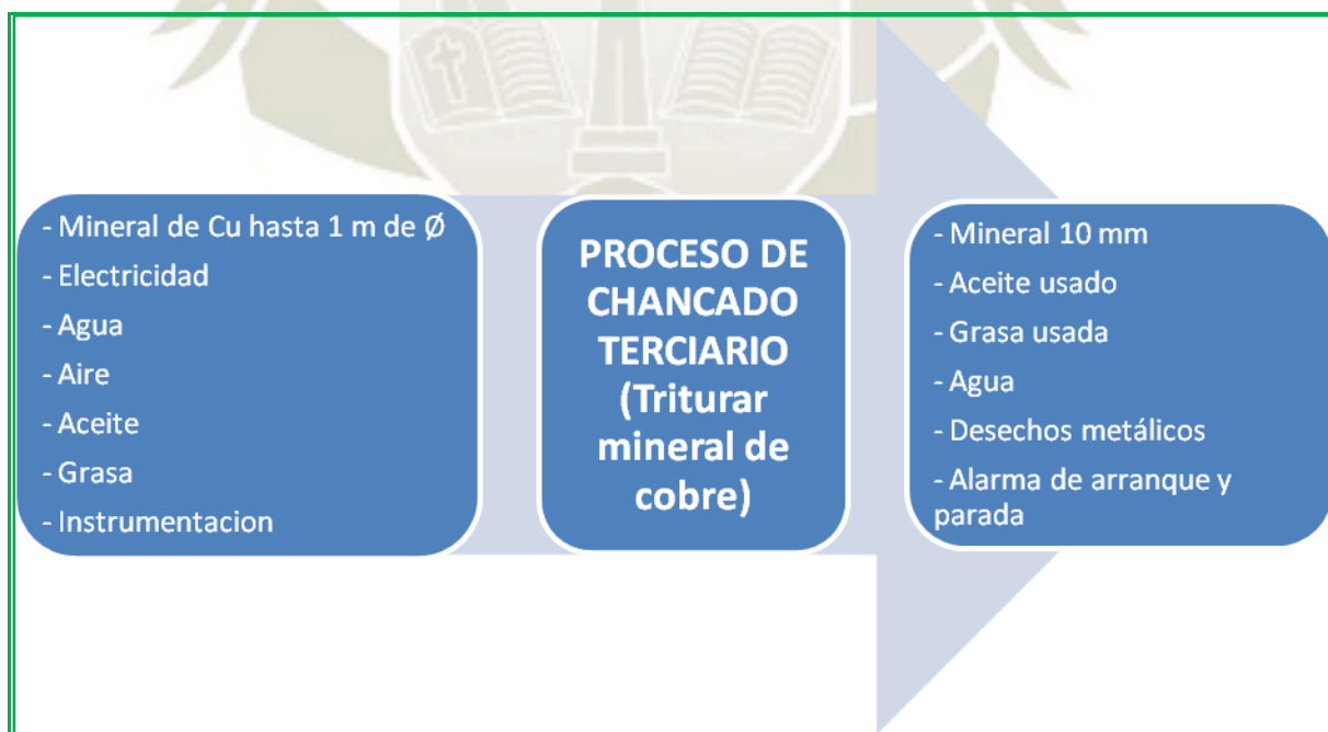
Figura 18 Entrada / Salida del Proceso de Chancado Terciario
