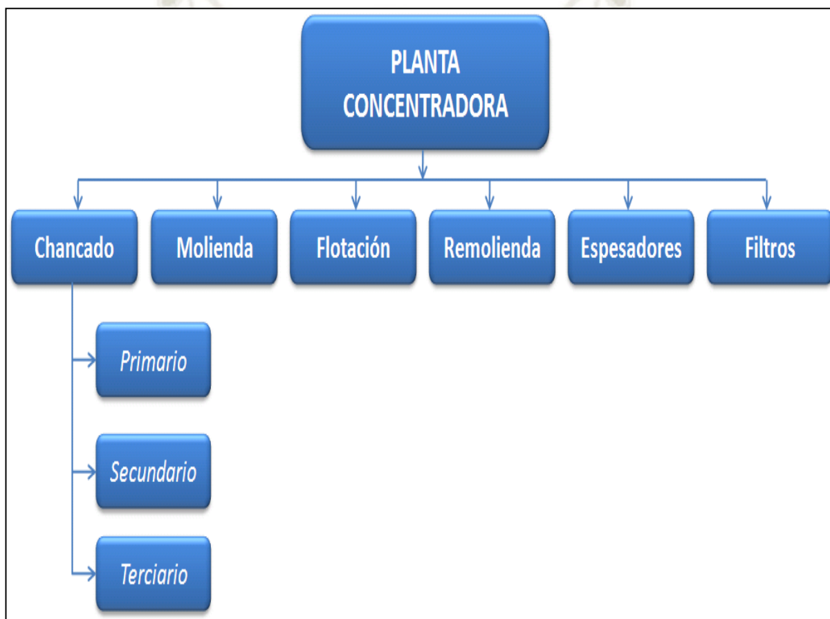
Figura 13 Procesos de la Planta Concentradora
