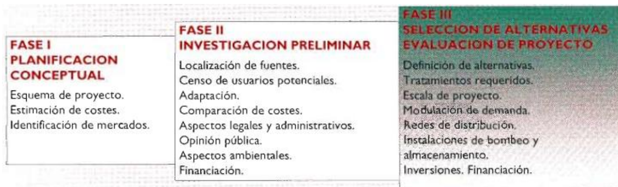
Figura 21. Condiciones de Diseño del sistema de recuperación de agua en plantas
