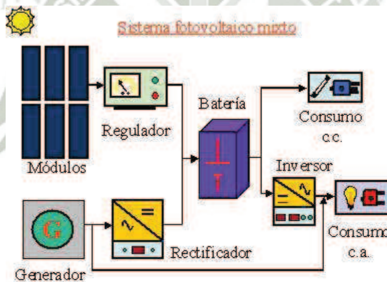
Figura 2.25: Esquema típico de un sistema mixto fotovoltaico-diesel.
