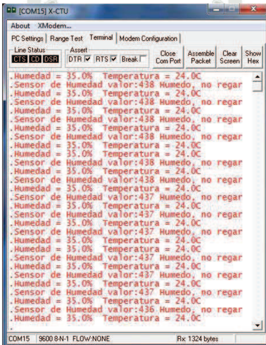
Figura 4.19: Test Recepción de datos en Coordinador en XCTU
