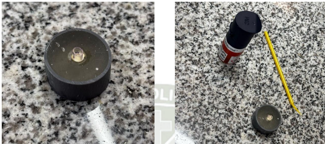
FIGURA 7. Confección de cilindro de resina con ayuda de una matriz transparente
