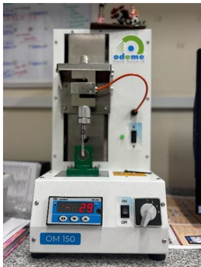
FIGURA 9. Test de resistencia de unión al cizallamiento
