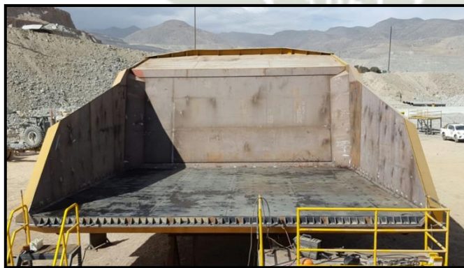
Figura 24 Tolva de camión minero desgastado
