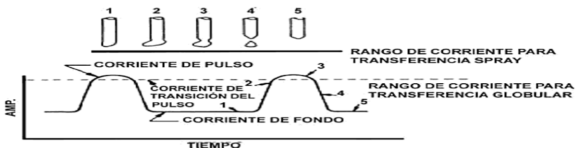
Figura 5 Transferencia por arco pulsado
