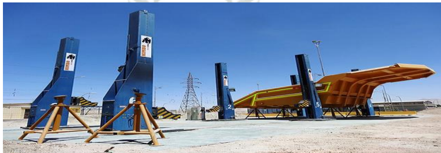
Figura 17 Mantenimiento de tolvas
