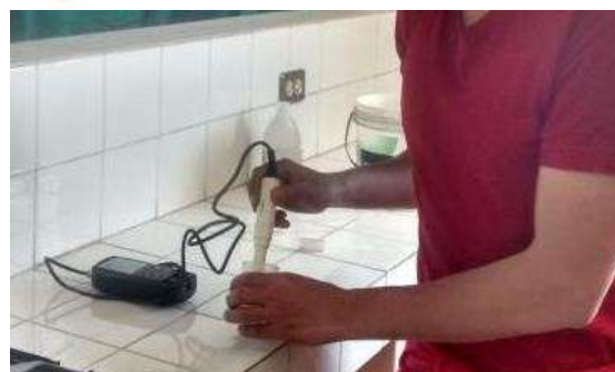
Fotografía N° 81: Muestra en el agitador. Fotografía N° 82: Medición pH y CE.
