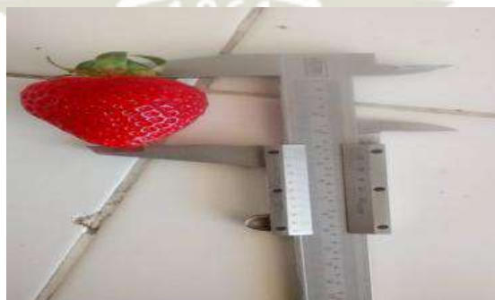
Fotografía N° 66: Medición del diámetro polar.
