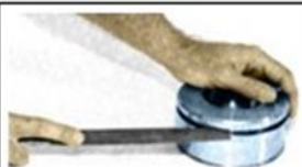
Fig. 12 Limpieza de émbolo con lima.
