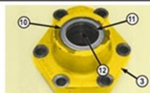
Fig. 7 Desmontaje de sellos de tapa de cilindro.
