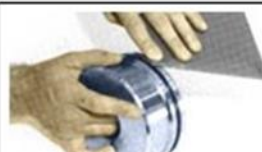
Fig. 11 Limpieza de émbolo con lija.
