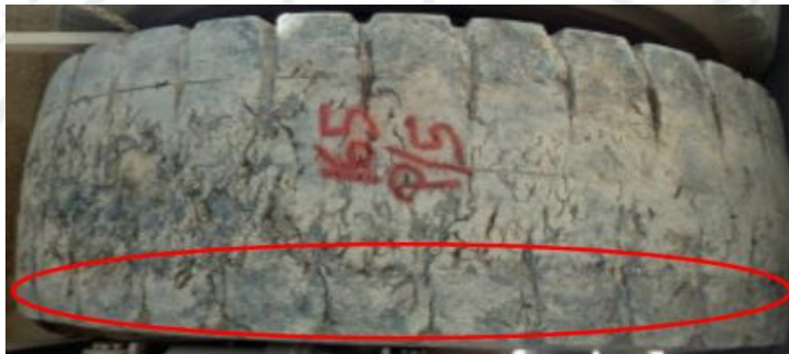
Desgaste irregular de neumático
