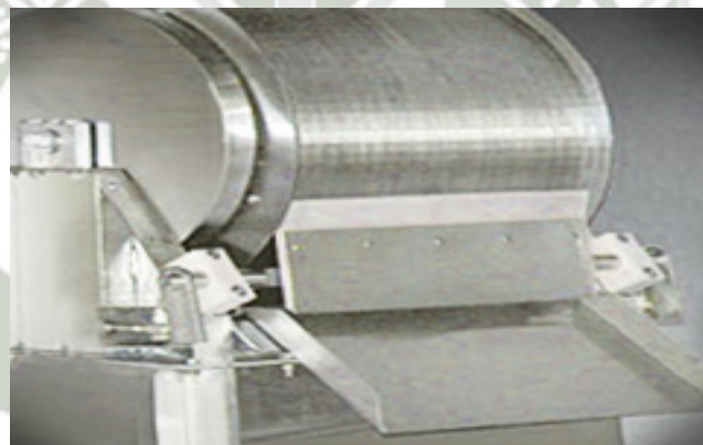
Figura 8: Fotografía Modelo de Separador de Sólidos
