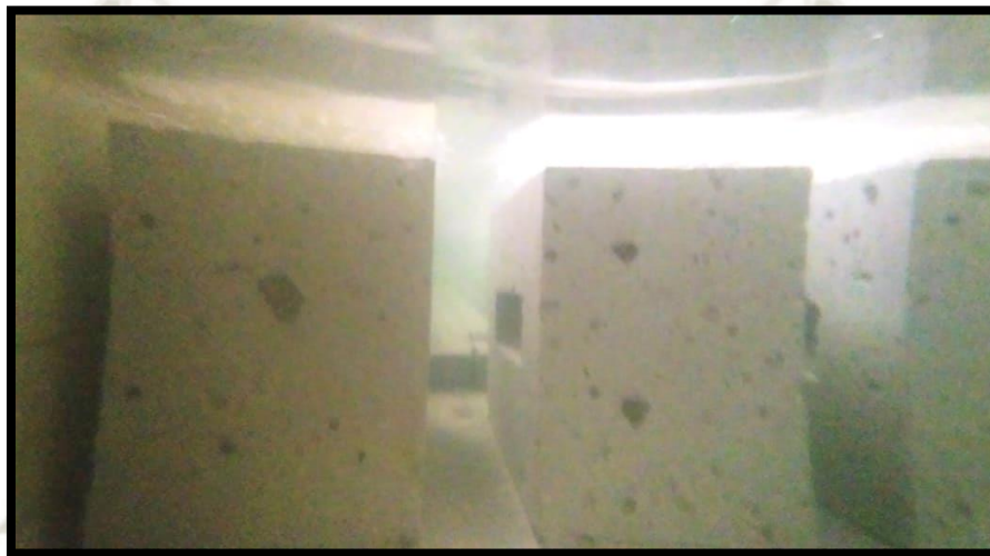
IMAGEN 3.05.- ENSAYO DE DENSIDAD: SATURACIÓN UNIDADES DE ALBAÑILERÍA DE SILLAR VISTA SUMERGIDA
