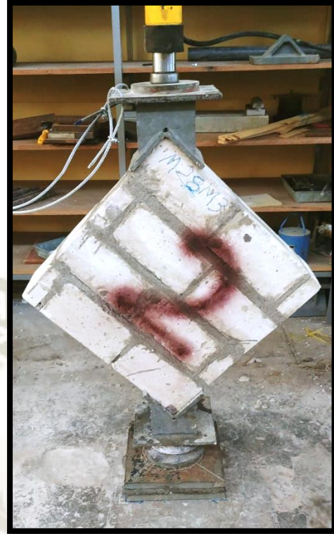
IMAGEN 3.35.- ENSAYO DE COMPRESIÓN DIAGONAL DE MURETES: MURETE DE UNIDAD DE ALBAÑILERÍA DE SILLAR TIPO M ANTES DE ROTURA
