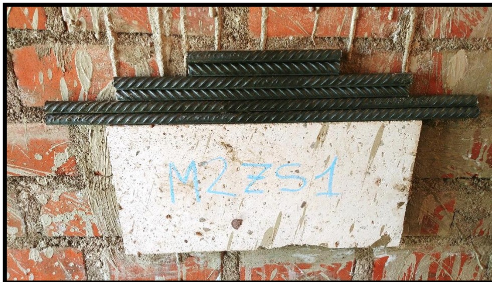
IMAGEN 4.08.- ENSAYO DE ADHESIÓN VERTICAL: ZÓCALO DE SILLAR CON MORTERO 2 SOMETIDO A 6kg DE MASA
