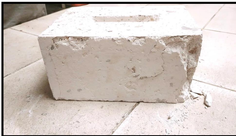
IMAGEN 3.15.- ENSAYO DE COMPRESIÓN AXIAL: UNIDAD DE ALBAÑILERÍA DE SILLAR TIPO M LUEGO DE ROTURA
