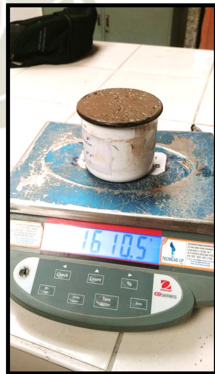
IMAGEN 4.04.- ENSAYO DE DENSIDAD DE MORTEROS: MASA DE RECIPIENTE Y MEZCLA
