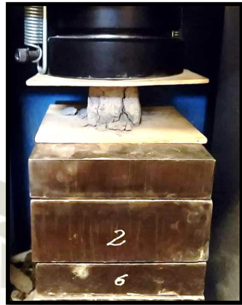
IMAGEN 4.06.- ENSAYO DE COMPRESIÓN DE MORTEROS: CUBO DE 5 X 5 CM DE MORTERO 03 POST COMPRESIÓN
