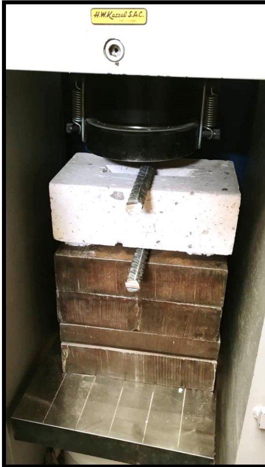
IMAGEN 3.20.- ENSAYO DE TRACCIÓN INDIRECTA: UNIDAD DE ALBAÑILERÍA DE SILLAR TIPO P DURANTE COMPRESIÓN
