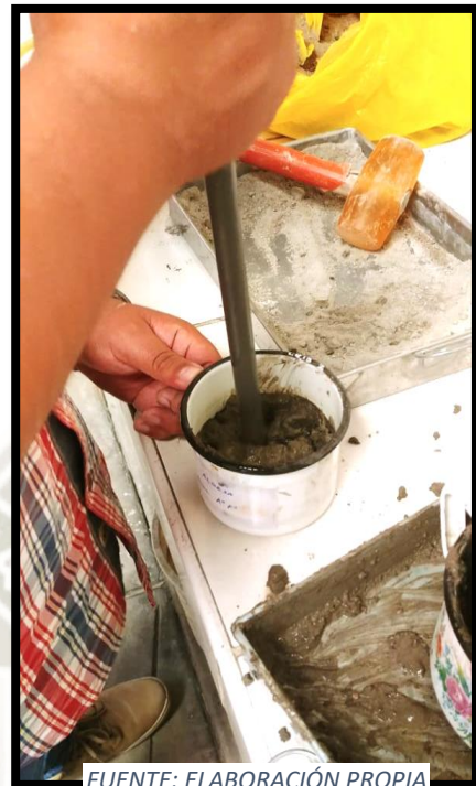
IMAGEN 4.04.- ENSAYO DE DENSIDAD DE MORTEROS: MASA DE RECIPIENTE Y MEZCLA
