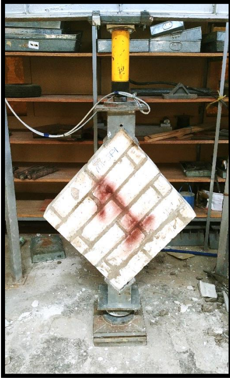
IMAGEN 3.34.- ENSAYO DE COMPRESIÓN DIAGONAL DE MURETES: MURETE DE UNIDAD DE ALBAÑILERÍA DE SILLAR TIPO P ANTES DE ROTURA
