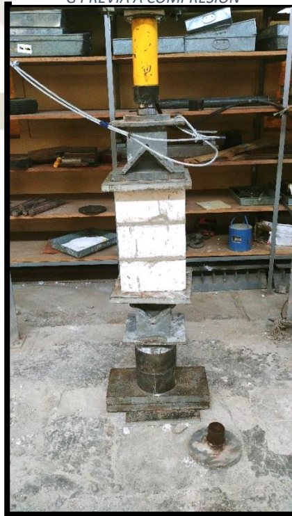
IMAGEN 3.27.- ENSAYO DE COMPRESIÓN AXIAL EN PRISMAS: PILA DE SILLAR TIPO G PREVIA A COMPRESIÓN
