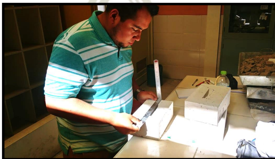
IMAGEN 3.04.- ENSAYO DE VARIABILIDAD DIMENSIONAL: MEDICIÓN DE LAS DIMENSIONES DE LA UNIDAD DE ALBAÑILERÍA DE SILLAR TIPO M
