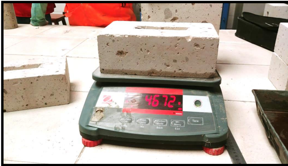
IMAGEN 3.11.- MASA DE LA UNIDAD DE ALBAÑILERÍA DE SILLAR LUEGO DE SUCCIONAR AGUA POR UN MINUTO
