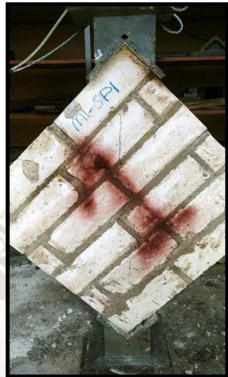
IMAGEN 3.38.- ENSAYO DE COMPRESIÓN DIAGONAL DE MURETES: MURETE DE UNIDAD DE ALBAÑILERÍA DE SILLAR TIPO P POST ROTURA, FALLA DIAGONAL
