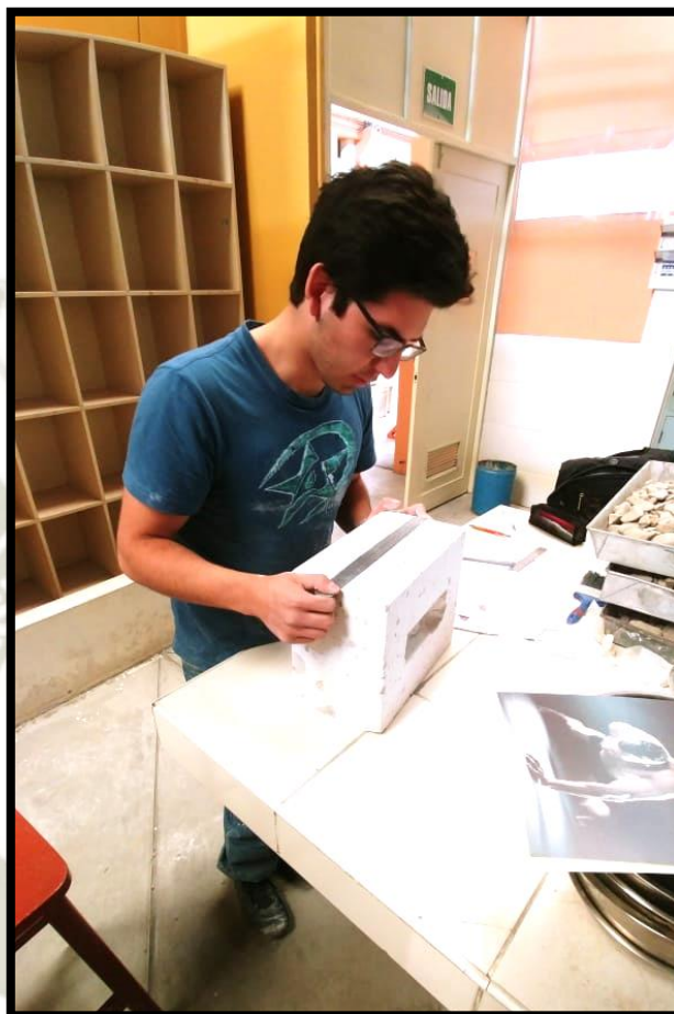
IMAGEN 3.03.- ENSAYO DE VARIABILIDAD DIMENSIONAL: MEDICIÓN DE LAS DIMENSIONES DE LA UNIDAD DE ALBAÑILERÍA DE SILLAR TIPO G
