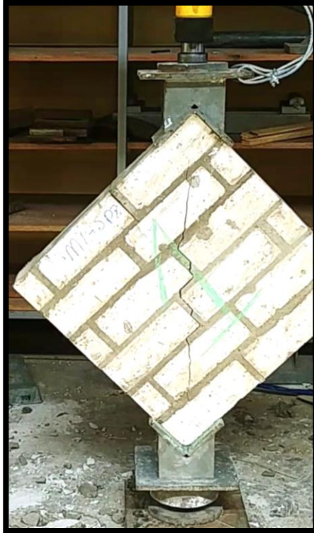
IMAGEN 3.37.- ENSAYO DE COMPRESIÓN DIAGONAL DE MURETES: MURETE DE UNIDAD DE ALBAÑILERÍA DE SILLAR TIPO P POST ROTURA, FALLA DIAGONAL
