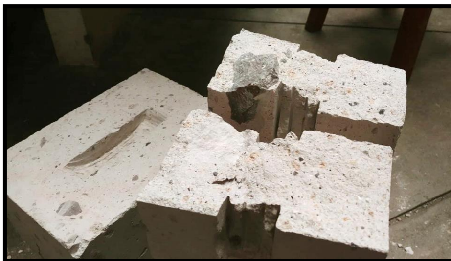
IMAGEN 3.24.- ENSAYO DE TRACCIÓN INDIRECTA: UNIDAD DE ALBAÑILERÍA DE SILLAR TIPO G LUEGO DE ROTURA
