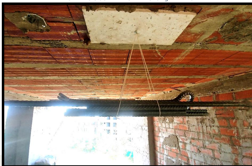
IMAGEN 4.14.- ENSAYO DE ADHESIÓN HORIZONTAL: ZÓCALO DE SILLAR CON MORTERO 3 SOMETIDO A 21.810 kg DE MASA
