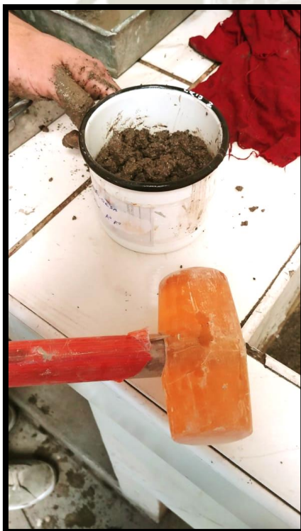
IMAGEN 4.03.- ENSAYO DE DENSIDAD DE MORTEROS: ELIMINACIÓN DE BURBUJAS DE AIRE CON MARTILLO DE GOMA
