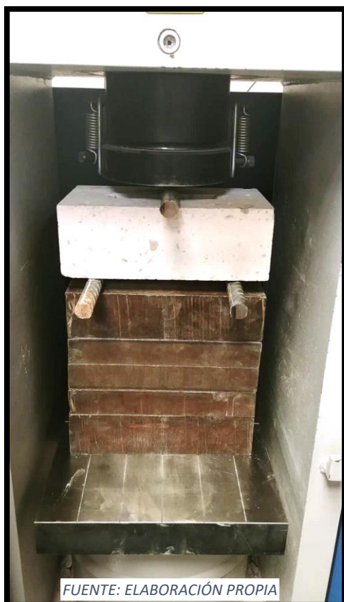
IMAGEN 3.18.- ENSAYO DE TRACCIÓN POR FLEXIÓN: UNIDAD DE ALBAÑILERÍA DE SILLAR TIPO P LUEGO DE ROTURA
