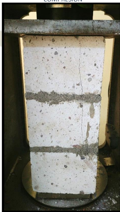
IMAGEN 3.30.- ENSAYO DE COMPRESIÓN AXIAL EN PRISMAS: PILA DE SILLAR TIPO M POST COMPRESIÓN
