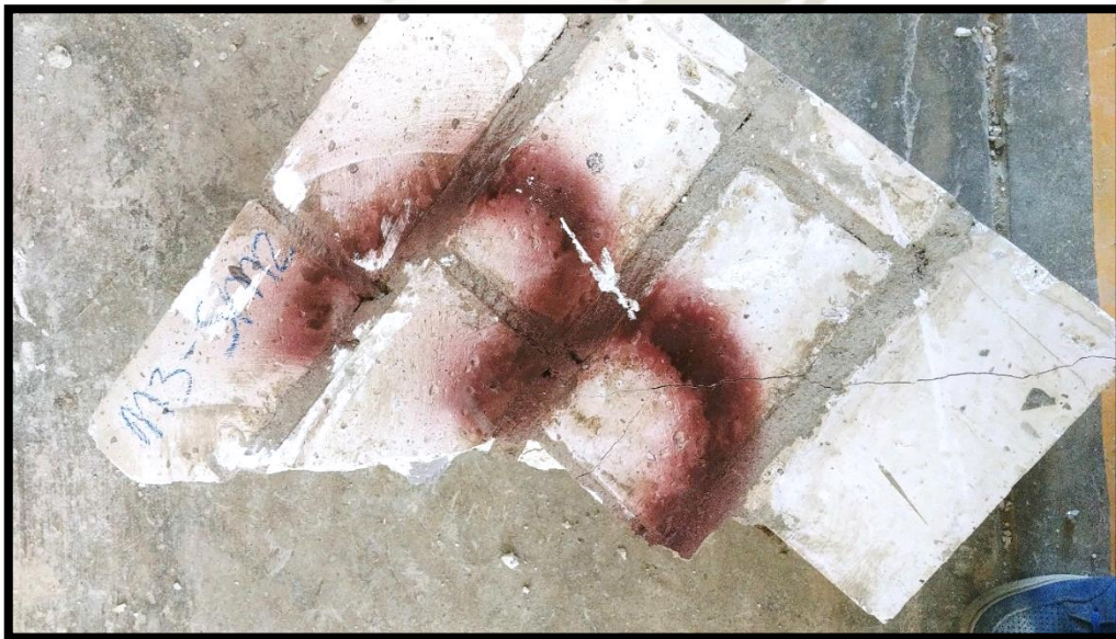
IMAGEN 3.39.- ENSAYO DE COMPRESIÓN DIAGONAL DE MURETES: MURETE DE UNIDAD DE ALBAÑILERÍA DE SILLAR TIPO M POST ROTURA, FALLA MIXTA
