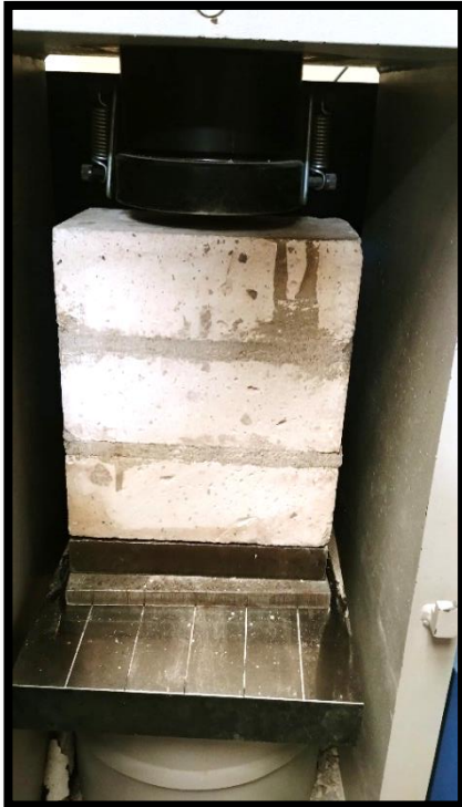
IMAGEN 3.25.- ENSAYO DE COMPRESIÓN AXIAL EN PRISMAS: PILA DE SILLAR TIPO P PREVIA A COMPRESIÓN
