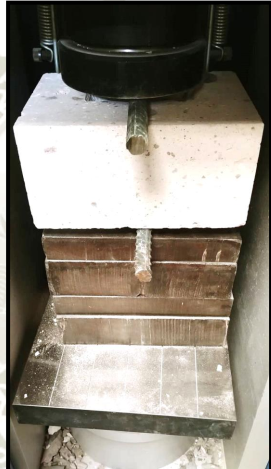
IMAGEN 3.21.- ENSAYO DE TRACCIÓN INDIRECTA: UNIDAD DE ALBAÑILERÍA DE SILLAR TIPO M DURANTE COMPRESIÓN
