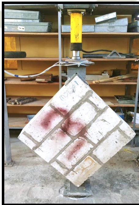
IMAGEN 3.36.- ENSAYO DE COMPRESIÓN DIAGONAL DE MURETES: MURETE DE UNIDAD DE ALBAÑILERÍA DE SILLAR TIPO G ANTES DE ROTURA
