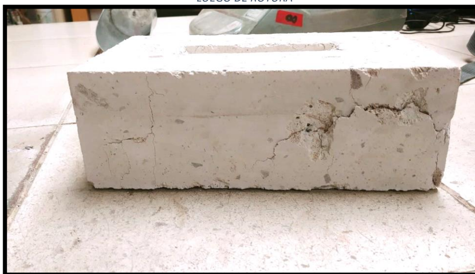
IMAGEN 3.14.- ENSAYO DE COMPRESIÓN AXIAL: UNIDAD DE ALBAÑILERÍA DE SILLAR TIPO P LUEGO DE ROTURA
