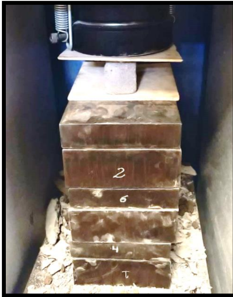
IMAGEN 4.05.- ENSAYO DE COMPRESIÓN DE MORTEROS: CUBO DE 5 X 5 CM DE MORTERO 01 ANTES DE COMPRESIÓN
