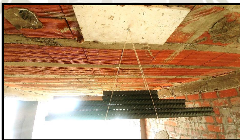
IMAGEN 4.13.- ENSAYO DE ADHESIÓN HORIZONTAL: ZÓCALO DE SILLAR CON MORTERO 03 SOMETIDO A 6kg DE MASA
