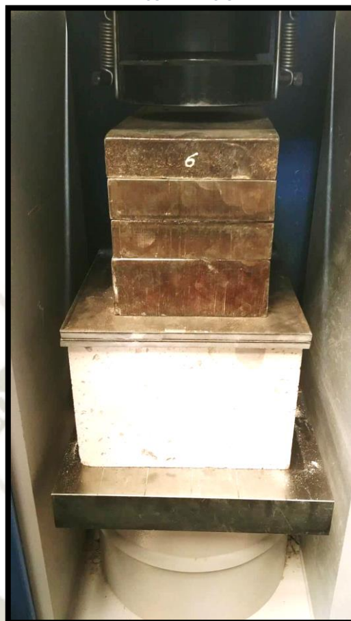
IMAGEN 3.13.- ENSAYO DE COMPRESIÓN AXIAL: UNIDAD DE ALBAÑILERÍA DE SILLAR TIPO G DURANTE LA COMPRESIÓN
