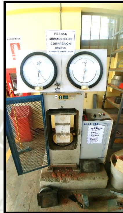
IMAGEN 3.26.- ENSAYO DE COMPRESIÓN AXIAL EN PRISMAS: PILA DE SILLAR TIPO M PREVIA A COMPRESIÓN
