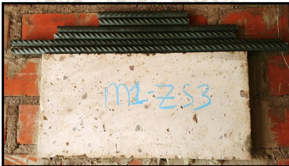
IMAGEN 4.07.- ENSAYO DE ADHESIÓN VERTICAL: ZÓCALO DE SILLAR CON MORTERO 01 SOMETIDO A 6kg DE MASA
