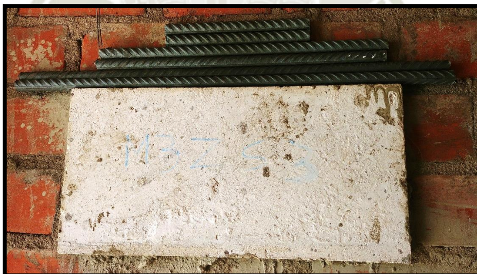
IMAGEN 4.09.- ENSAYO DE ADHESIÓN VERTICAL: ZÓCALO DE SILLAR CON MORTERO 3 SOMETIDO A 6kg DE MASA
