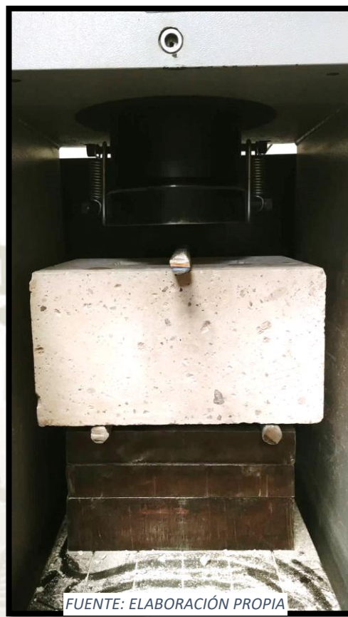
IMAGEN 3.18.- ENSAYO DE TRACCIÓN POR FLEXIÓN: UNIDAD DE ALBAÑILERÍA DE SILLAR TIPO P LUEGO DE ROTURA
