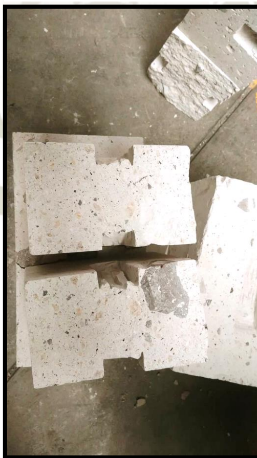
IMAGEN 3.23.- ENSAYO DE TRACCIÓN INDIRECTA: UNIDAD DE ALBAÑILERÍA DE SILLAR TIPO M LUEGO DE ROTURA
