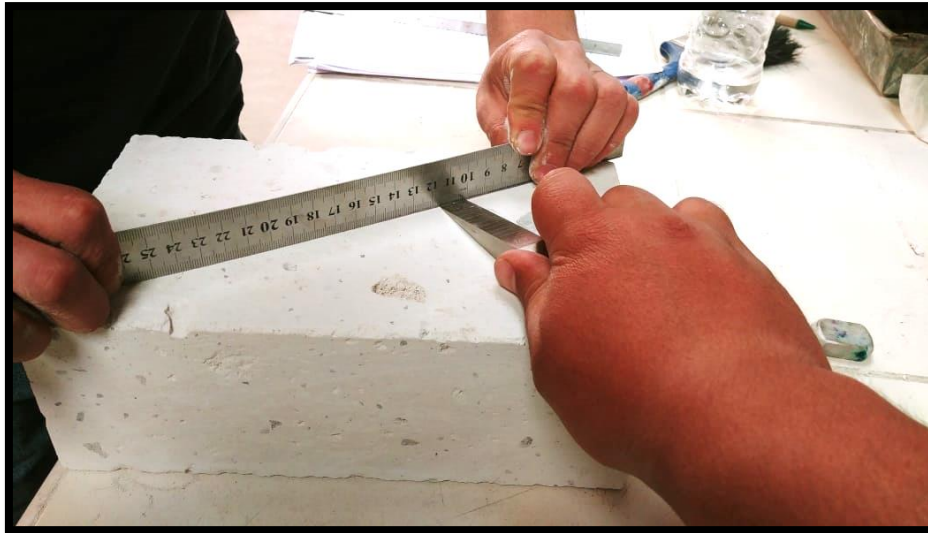
IMAGEN 3.02.- ENSAYO DE ALABEO: MEDICIÓN DE ALABEO DE LA DIAGONAL EN UNIDAD DE ALBAÑILERÍA TIPO P
