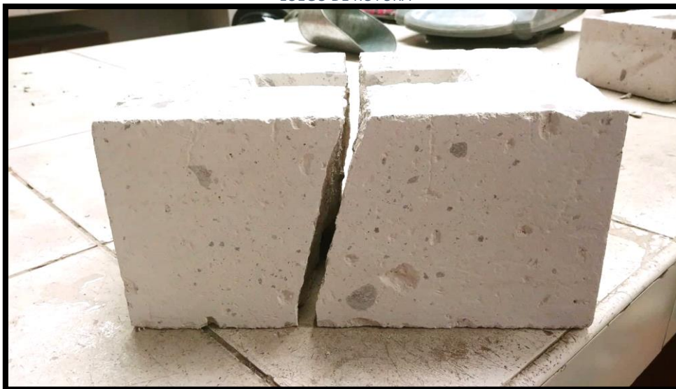
IMAGEN 3.22.- ENSAYO DE TRACCIÓN INDIRECTA: UNIDAD DE ALBAÑILERÍA DE SILLAR TIPO M LUEGO DE ROTURA
