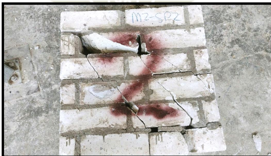
IMAGEN 3.41.- ENSAYO DE COMPRESIÓN DIAGONAL DE MURETES: MURETE DE UNIDAD DE ALBAÑILERÍA DE SILLAR TIPO P POST ROTURA, FALLA DOBLE DIAGONAL
