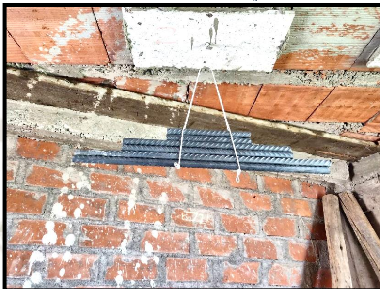
IMAGEN 4.12.- ENSAYO DE ADHESIÓN HORIZONTAL: ZÓCALO DE SILLAR CON MORTERO 02 SOMETIDO A 6kg DE MASA
