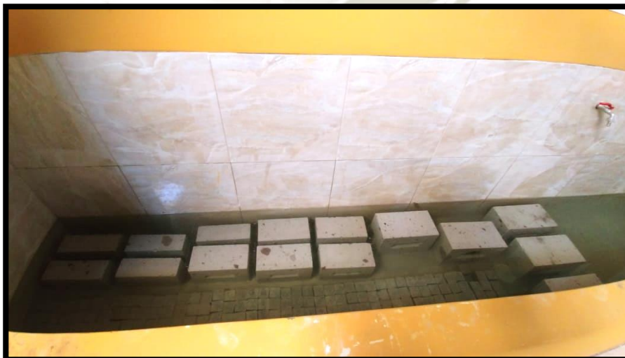
IMAGEN 3.06.- ENSAYO DE DENSIDAD: SATURACIÓN UNIDADES DE ALBAÑILERÍA DE SILLAR VISTA AÉREA
