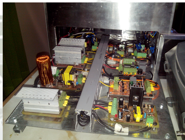
(b) Fotografía del generador de ultrasonido, fijado y ubicado mediante un riel telescópico.
