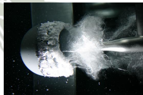
(b) Implosión de una cavidad en cercanía a una superficie.
