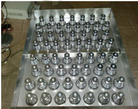
(c) Detalle de montaje de transductores de ultrasonido en un contenedor impermeable. Fuente: www.bjultrasonic.com/
