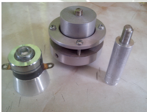
(a) Partes del conjunto acústico: Transductor piezoeléctrico, transformador acústico y sonda ultrasónica de sacrificio, de izquierda a derecha correspondientemente.
