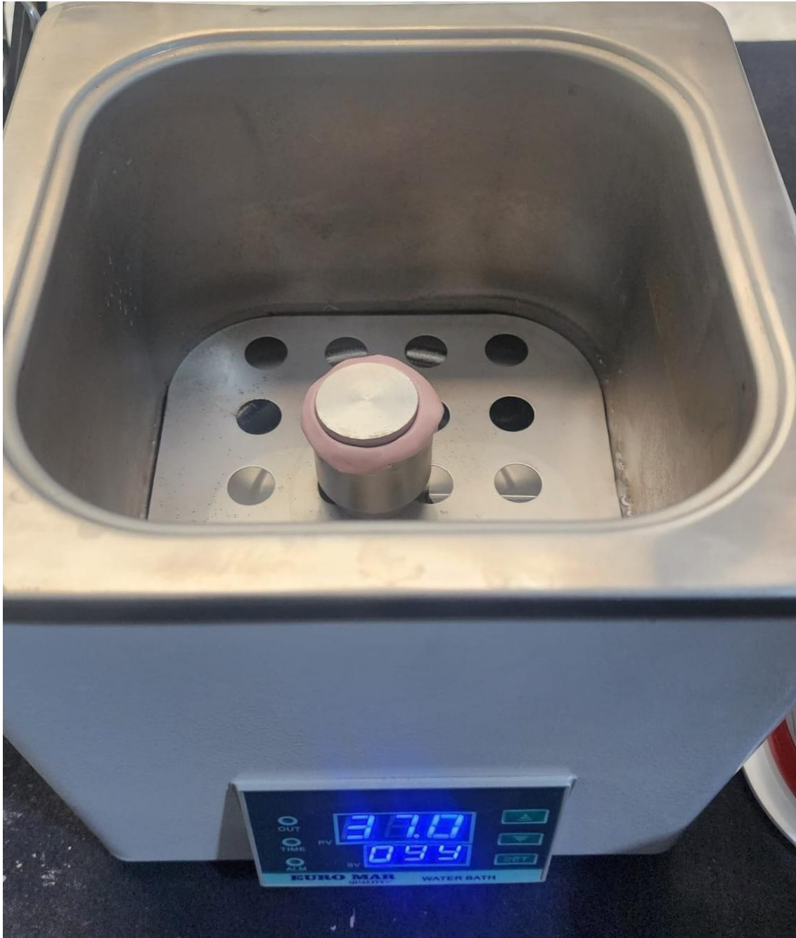
Foto 8: Dispositivo N°19 con la muestra de silicona de laboratorio en baño digital a 37°
