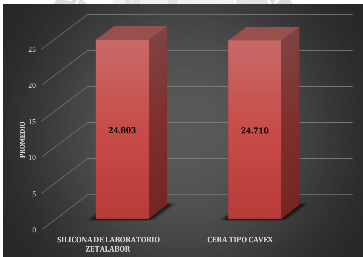
Figura 5. Comparación de la longitud (mm) promedio a los 5 minutos: silicona de laboratorio Zetalabor y Cera Tipo Cavex
