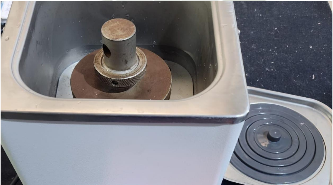
Foto 10 y 11. Dispositivo N°19 con la muestra de silicona de laboratorio ZETALABOR en baño maría digital a 37° con el peso de 500mg
