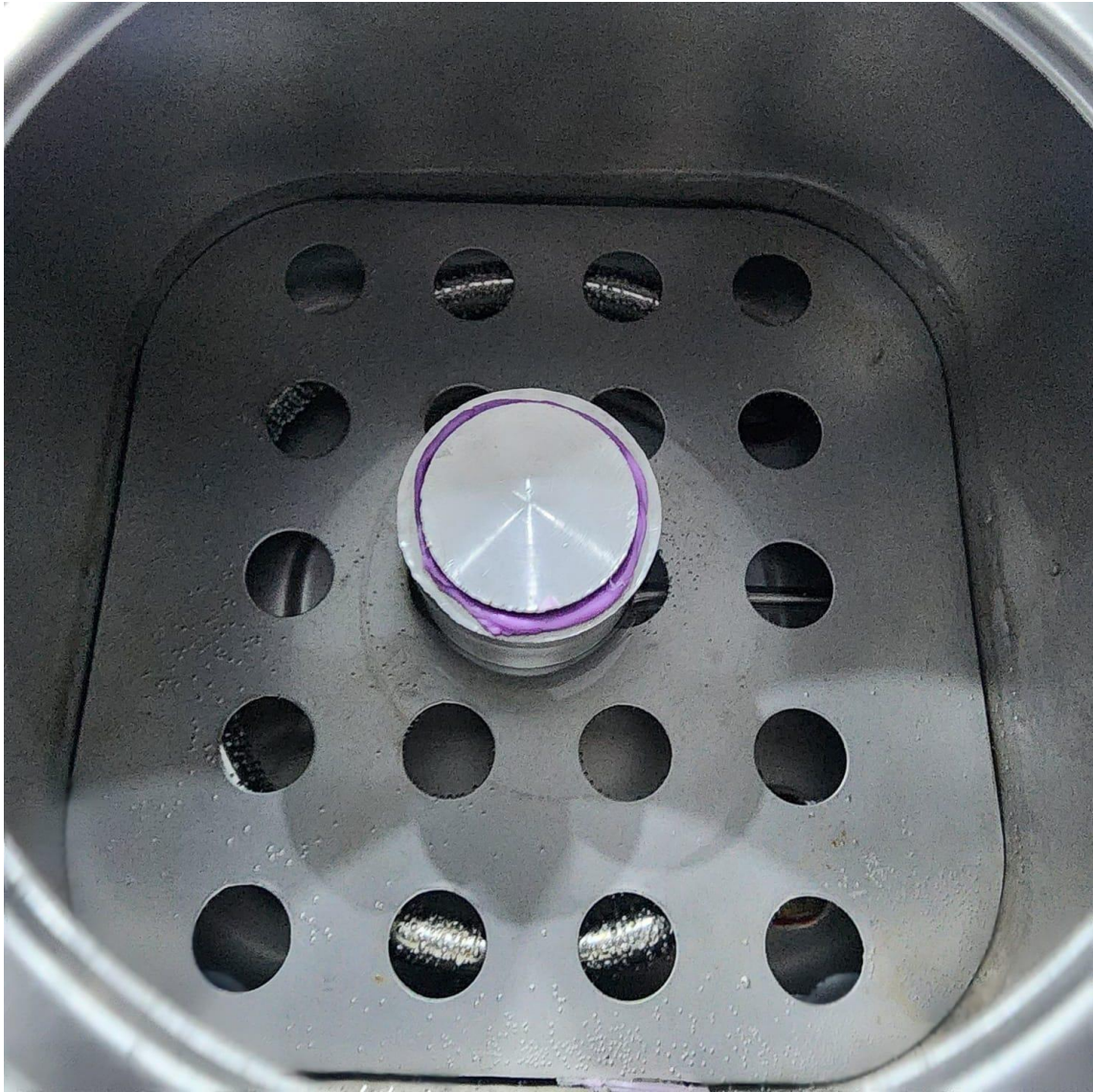
Foto 7: Dispositivo N°19 con la muestra de silicona de registro OCCLUFAS T ROCK en baño digital a 37°
