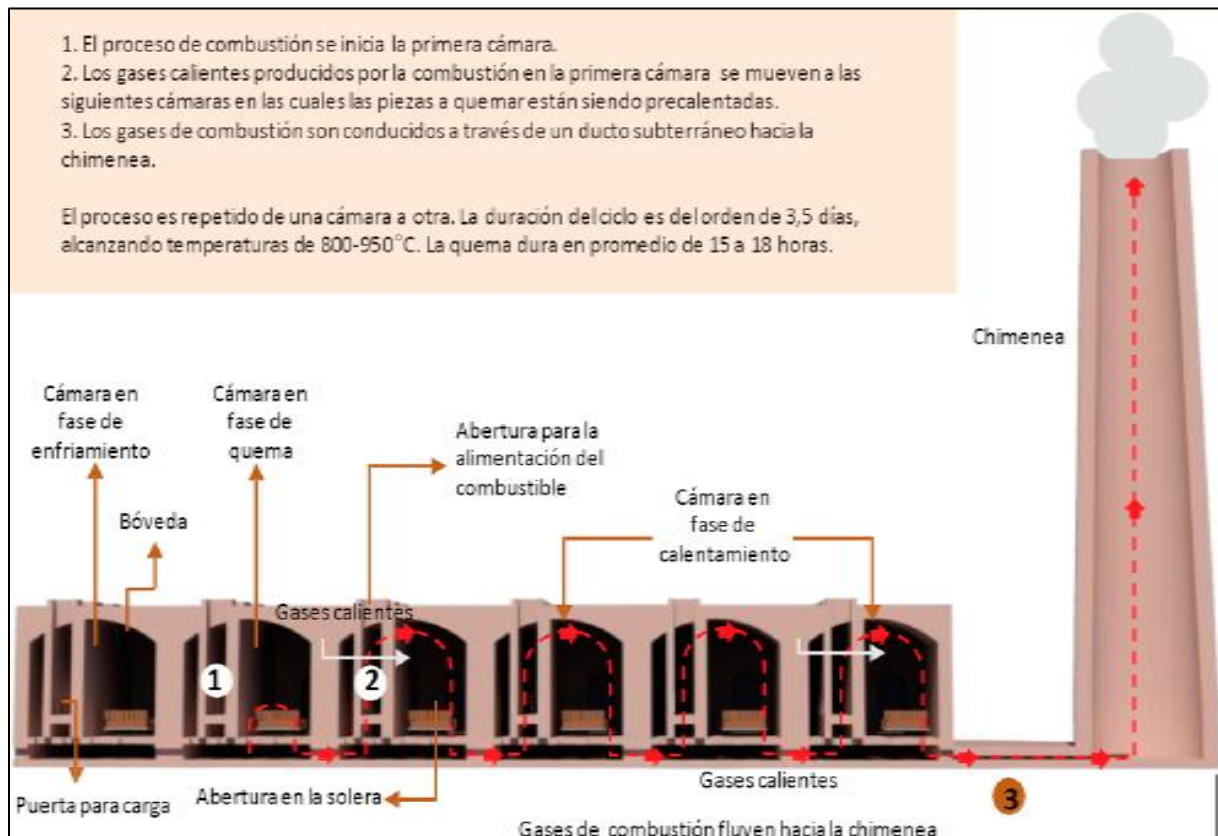
Figura 6. Diagrama de funcionamiento del Horno Cedan
