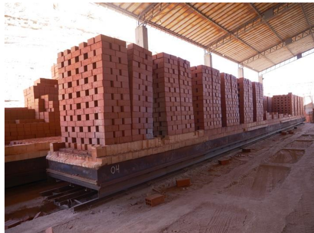
Riel de carga de producto terminado
