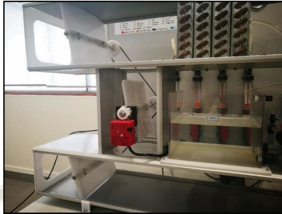
Figura 94: Posición cerrada de las compuertas de entrada y salida de aire
