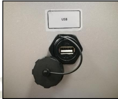
Figura 87: Puerto USB del módulo de aire acondicionado.
