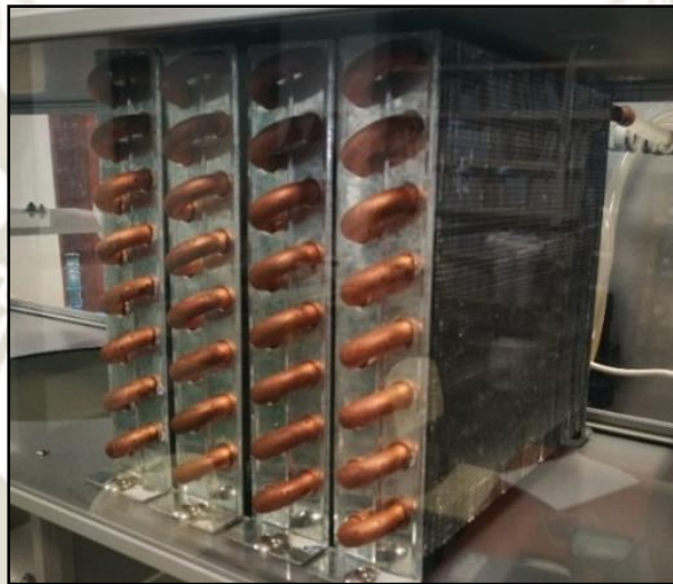
Figura 69: Evaporador de agua helada de 19cm x 19.5cm x 20cm.
