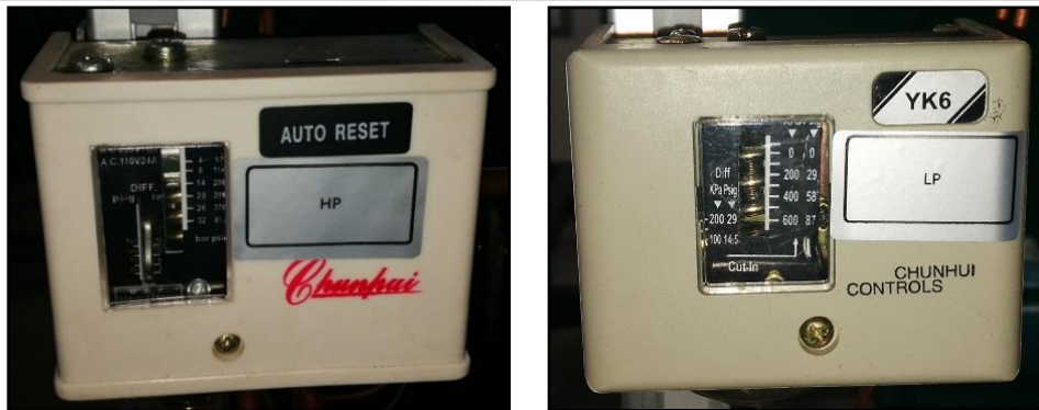
Figura 85: Interruptores de alta y baja presión.
