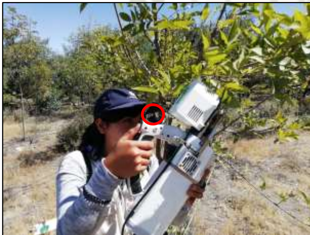
Figura 15. Medición de la incidencia solar utilizando sensor Li-190 R (Fuente: Elaboración propia)
