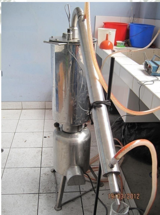
Fig.1. Equipo de Arrastre con Vapor para el proceso de Extracción del Aceite Esencial
