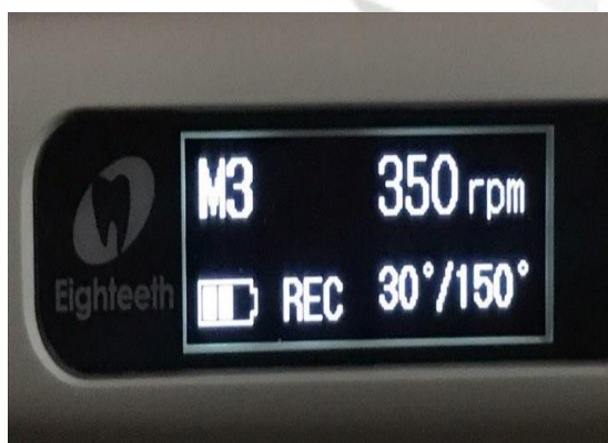
Movimiento controlado con giro recíproco de 150°/30° a una velocidad de 350 RPM
