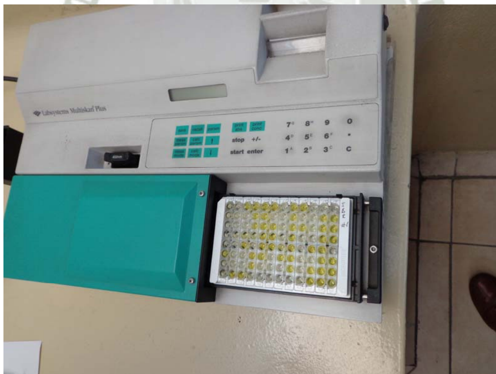
FOTO N° 12: PLACA INGRESANDO AL ESPECTOFOTÓMETRO
