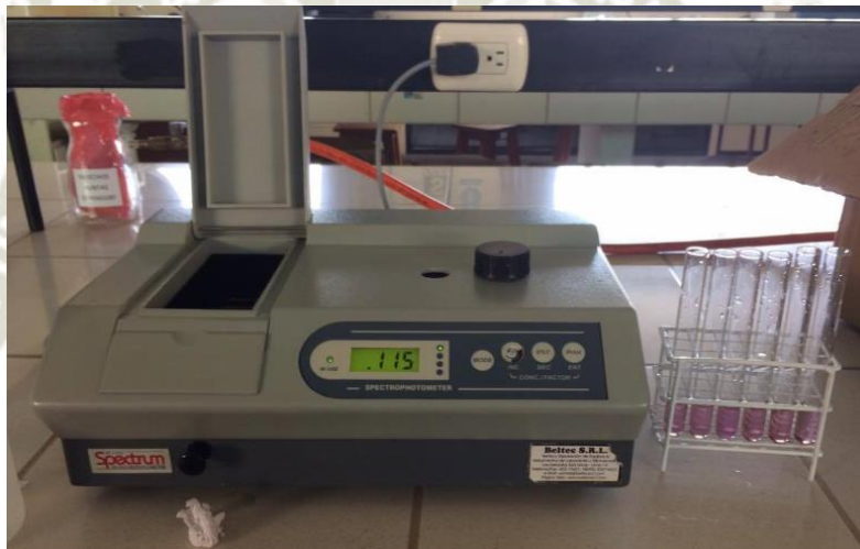
Figura N°8: se llevó al espectro y se midió a dos longitudes de onda a 510 nm y a 700 nm
