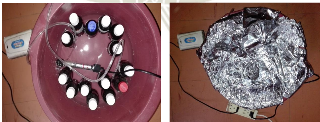
Figura N°6 diseño del termostato casero (termostato de pecera para la T°, aireador para distribuir equitativamente el agua caliente, papel aluminio para el ambiente oscuro)
