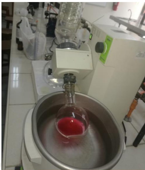
Figura N°19: Se llevó a un evaporador para disminuir el volumen por evaporación de etanol
