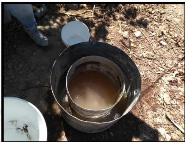
Fotografía 3: Colocada de cilindros
