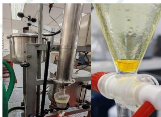
Figura 2. Equipo de destilación por arrastre de vapor y separación del aceite esencial mediante pera de decantación
