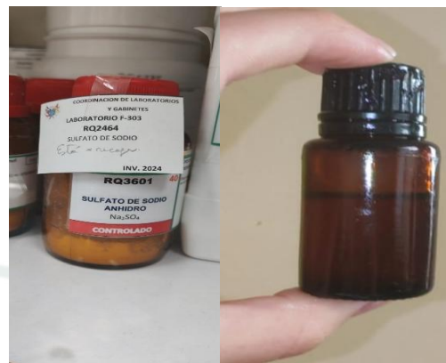
Figura 4. Secado y purificación mediante tratamiento con sulfato de sodio anhidro y obtención del aceite esencial libre de humedad
