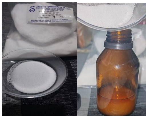
Figura 5. Purificación mediante tratamiento con solución sobresaturada de sal química y secado con sulfato de sodio anhidro.
