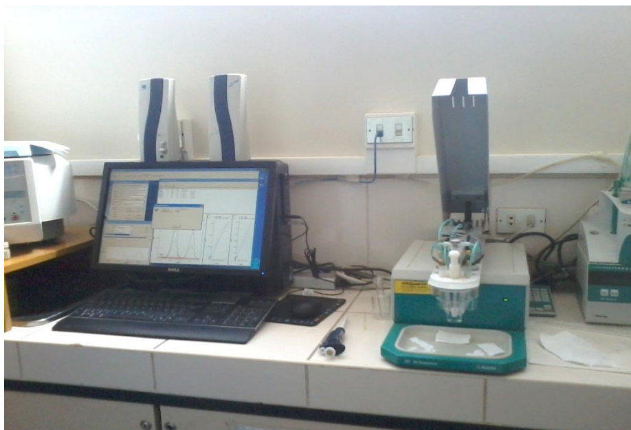
Figura 22. Analizador voltamperométrico (derecha), ligado al computador para registro de análisis.
