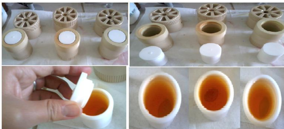
Figura 19. Digestión a presión por microondas de las muestras de miel de abejas
