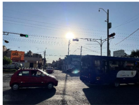
Foto 30: Deslumbramiento de la semaforización vehicular
