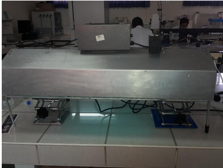
Anexo 8. 7 Lámpara UV-A de trabajo (emisión 365 nm).
