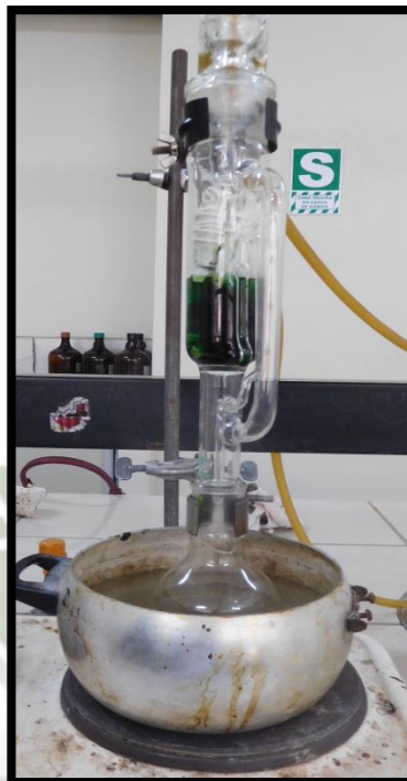
FIGURA N°6: Extracción por Soxhlet de hojas de Cestrum auriculatum L'Hér.
