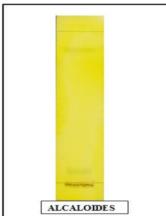
FIGURA N°13. Cromatografía de capa fina del Extracto Alcohólico de Cestrum auriculatum L'Hér. “Hierba santa” para la identificación de alcaloides.
