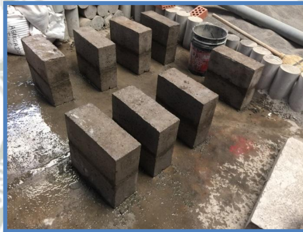
Figura 41 Curado de pilas siendo humedecidas.
