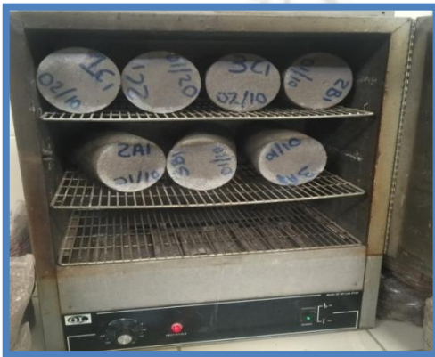
Figura 34 Ensayo de absorción secado de probetas en horno del laboratorio para obtener su peso seco.
