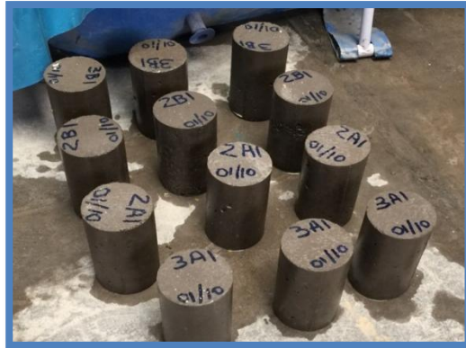
Figura 33 Ensayo de absorción probetas superficialmente secas
