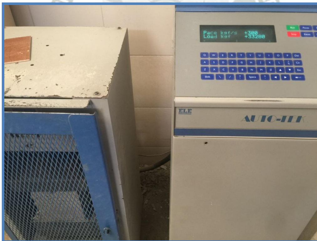
Figura 37 Toma de dato de la presión que logra resistir cada unidad de bloqueta
