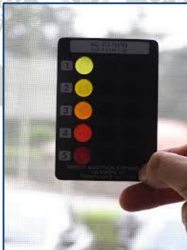
Figura 16 Diferentes colores patrones para el ensayo de impurezas orgánicas
