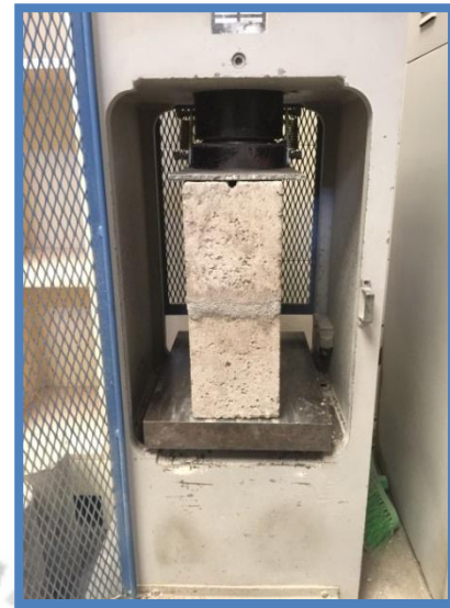
Figura 43 Ensayo a compresión axial de pilas
