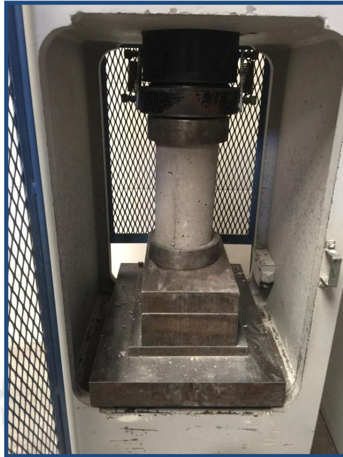
Figura 32 Rotura de Probeta en el laboratorio de la UCSM
