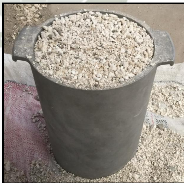
Figura 29 Ensayo Peso unitario suelto y compactado de la Piedra Pómez
