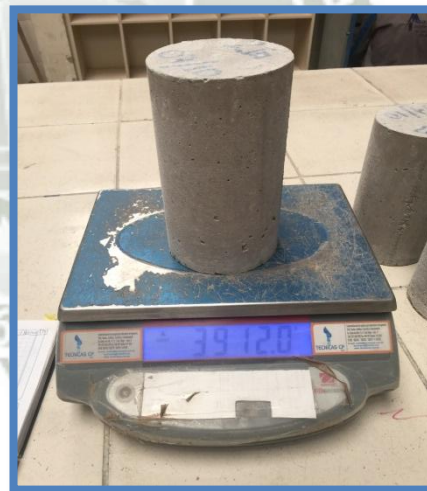
Figura 34 Ensayo de absorción secado de probetas en horno del laboratorio para obtener su peso seco.
