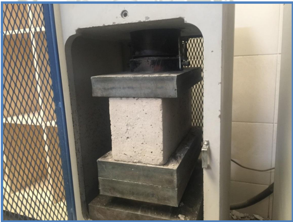
Figura 35 Ensayo a la compresión de la bloqueta de concreto artesanal.
