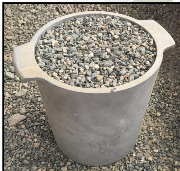
Figura 28 Ensayo Peso unitario suelto y compactado Agregado grueso Poderosa
