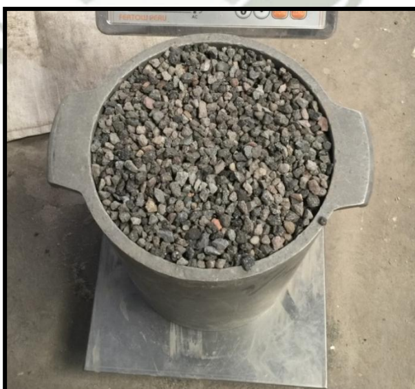
Figura 27 Ensayo peso unitario suelto y compactado Agregado grueso Chiguata
