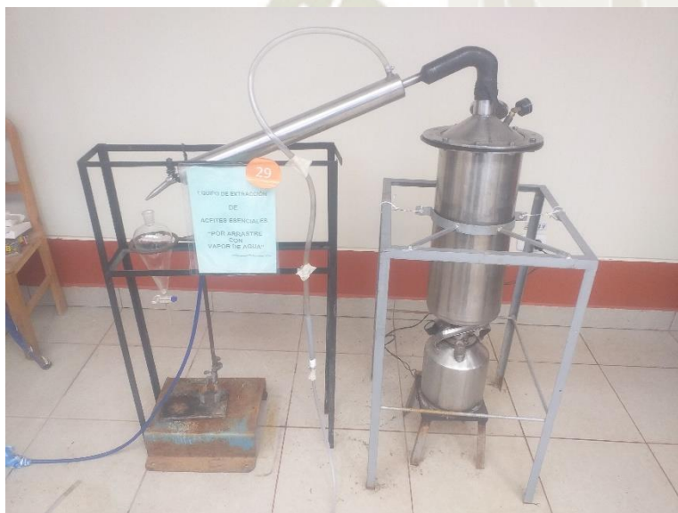
Fotografía N°3 Equipo de extracción de aceite esenciales por destilación por arrastre con vapor de agua
