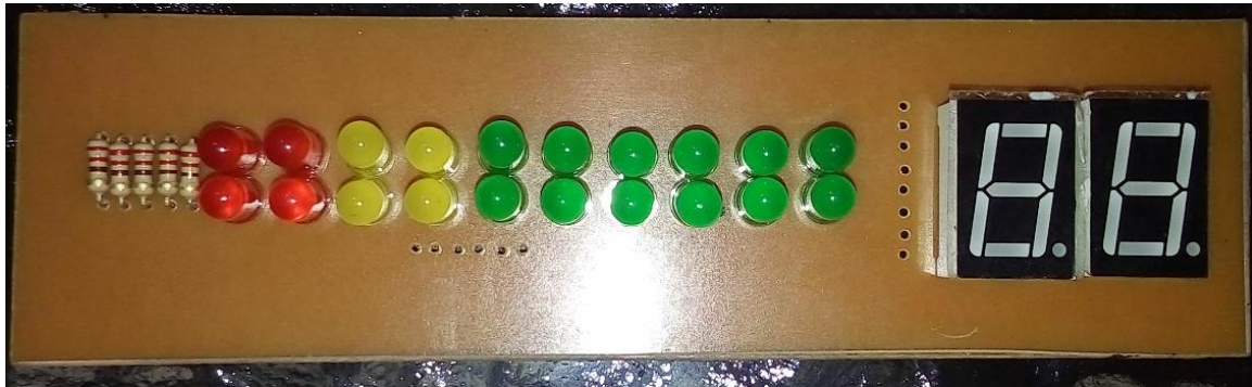
Imagen 61. Placa de Semáforos y Displays. Fuente: Elaborado por los Autores.
