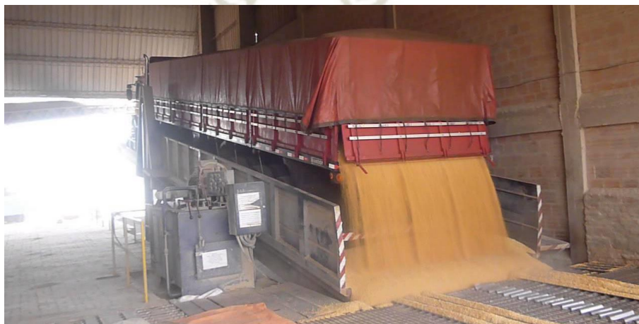
Figura N° 11: Descarga de trigo en poza de recepción Fuente; Molino las Mercedes S.A.C.
