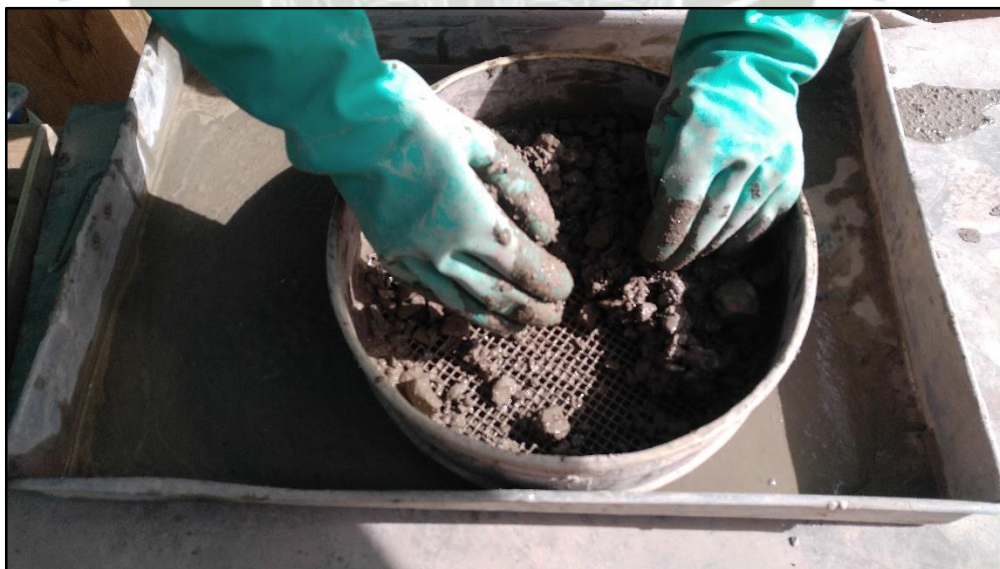
Ilustración 2: Preparación de mortero para ensayo de Tiempo de Fraguado
