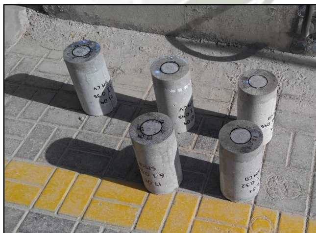
Ilustración 14: Preparación de especímenes para Ensayo de Permeabilidad
