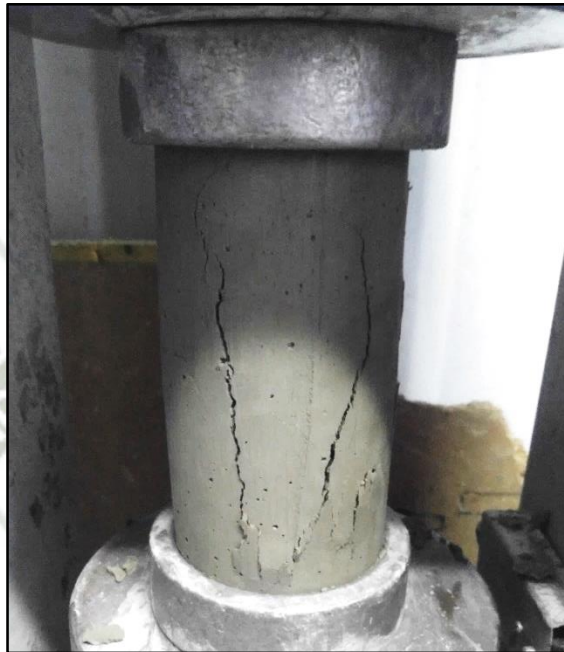
Ilustración 9: Ensayo de Resistencia a la Compresión
