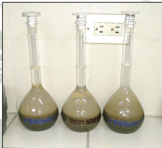
Ilustración 23: Peso específico del agregado fino
