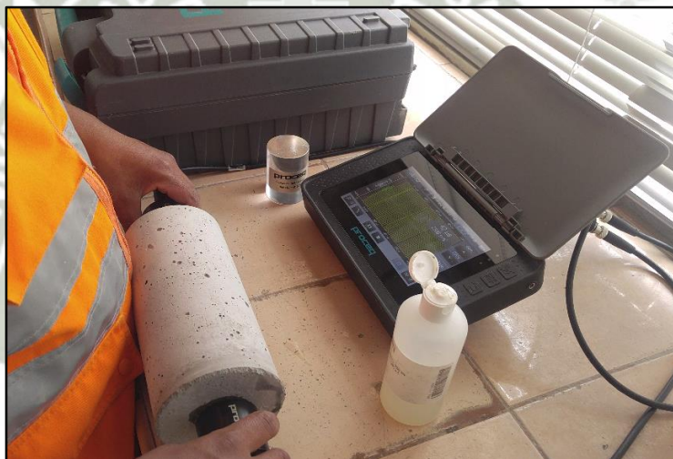
Ilustración 5: Ensayo de Velocidad de Pulso Ultrasónico
