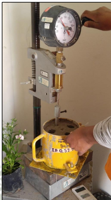
Ilustración 3: Ensayo de tiempo de fraguado por resistencia a la Penetración
