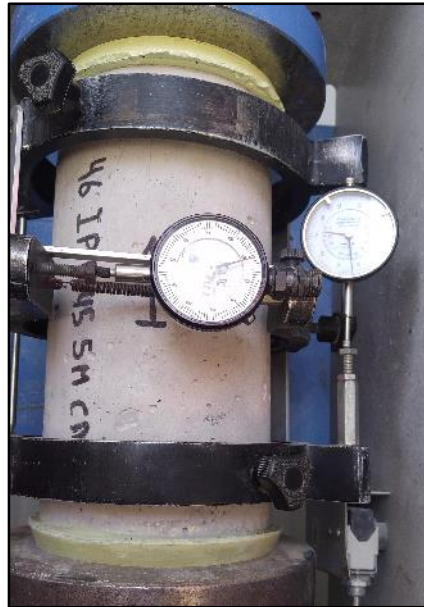
Ilustración 17: Ensayo de Módulo de Elasticidad
