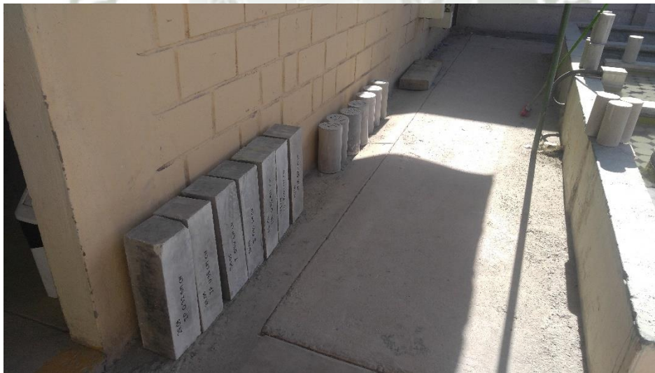
Ilustración 2: Vigas y Probetas Cilíndricas para ensayo
