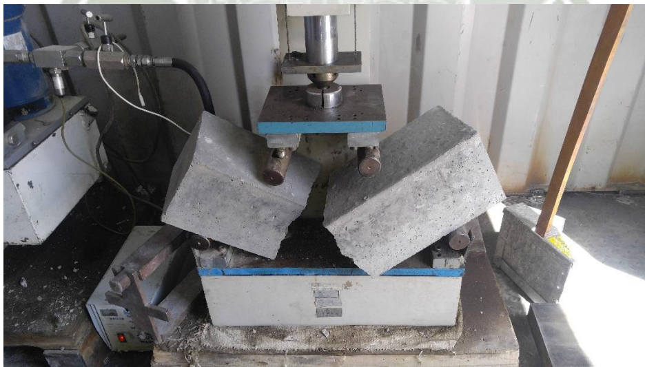
Ilustración 4: Ensayo Modulo de rotura Fase final
