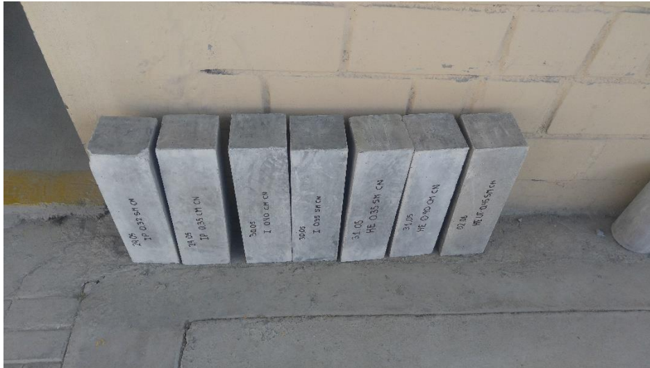
Ilustración 1: Vigas para ensayo de Flexión o Modulo de rotura
