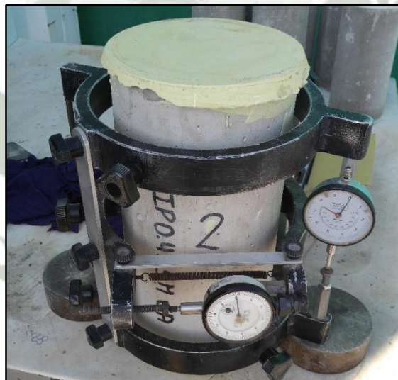
Ilustración 16: Preparación de espécimen para ensayo de Módulo de elasticidad.
