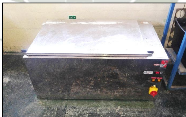
Ilustración 18: Cámara de curado a vapor
