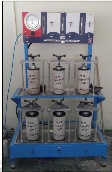
Ilustración 15: Ensayo de Permeabilidad al agua bajo presión
