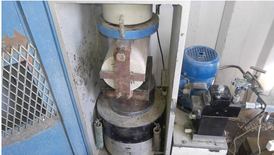
Ilustración 5: Ensayo de Tracción Indirecta
