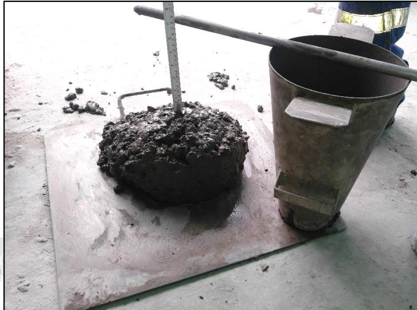
Ilustración 1: Asentamiento del Concreto (SLUMP)
