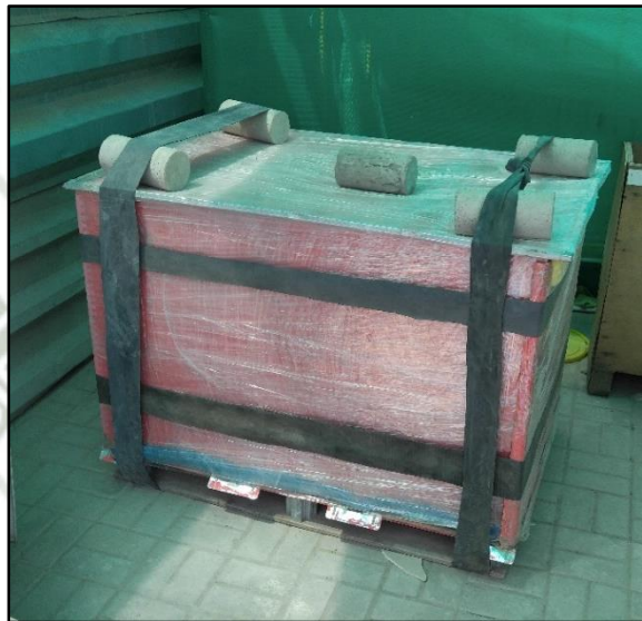
Ilustración 21: Cámara de curado Adiabática
