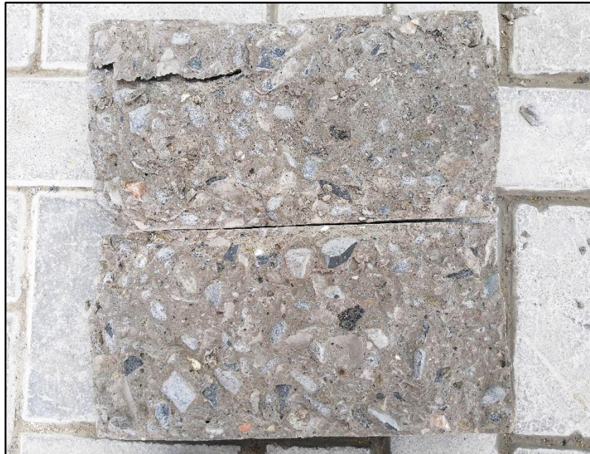
Ilustración 13: Probeta de concreto ensayada a tracción indirecta
