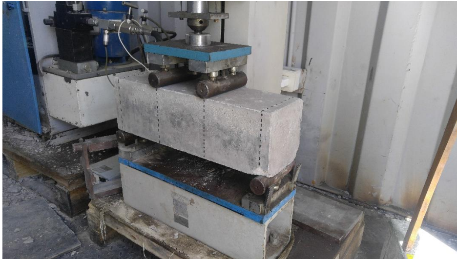
Ilustración 3: Ensayo del Módulo de rotura Fase previa
