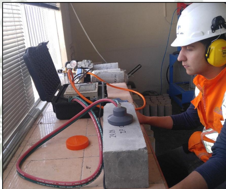
Ilustración 4: Ensayo de Permeabilidad al aire de Torrent
