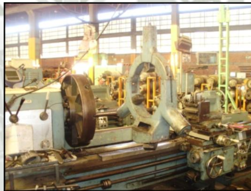
Fig. N°4. Luneta para rectificado de Cilindros de Laminación. Referencia: Aceros Arequipa – Planta N°1.
