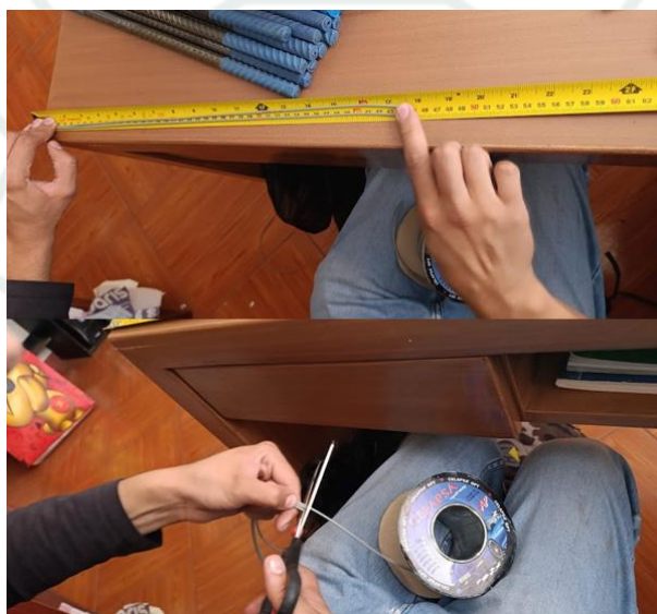
Figura 117 Preparación de cables
