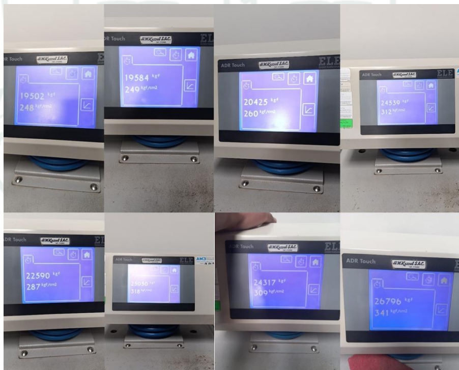
Figura 110 Detalle de rotura de especímenes de concreto sometidos a compresión axial a los 28 días de curado
