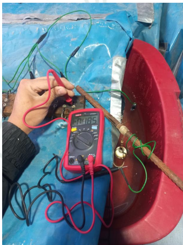
Figura 76 Medición de potencial ON ánodo de sacrificio
