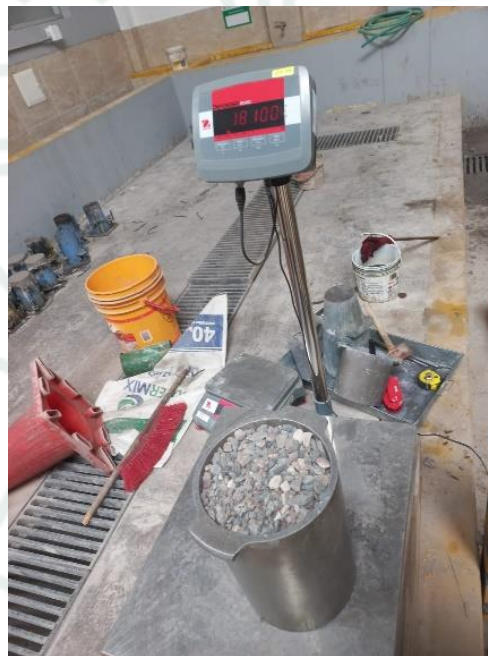
Figura 100 Pesaje de agregado para ensayo de peso unitario
