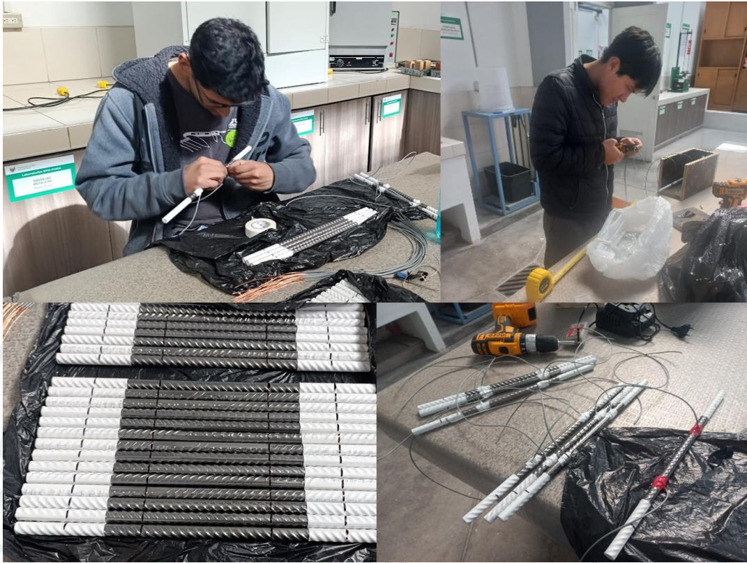
Figura 118 Colocación de cables sujeto al acero
