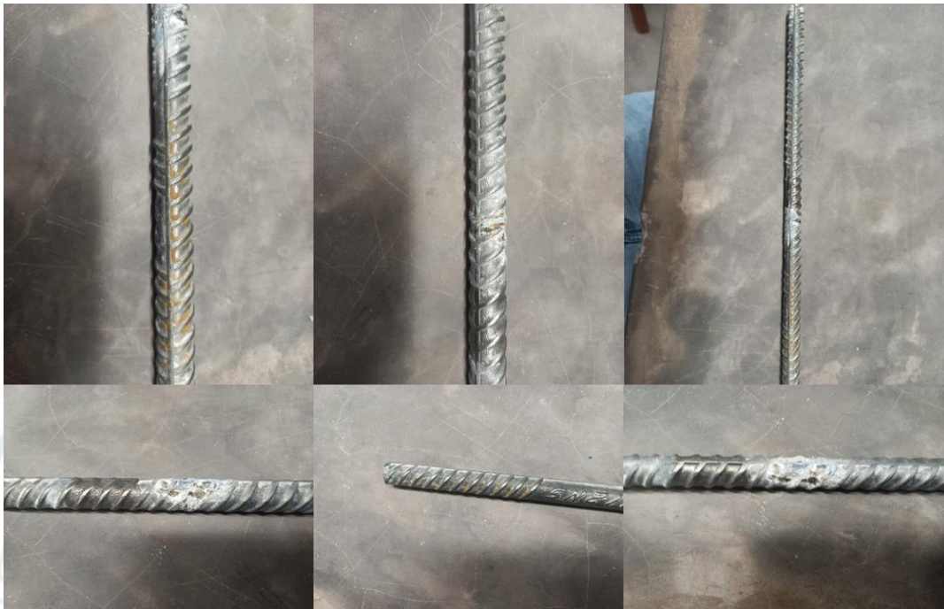
Figura 150 Extracción y limpieza de los aceros
