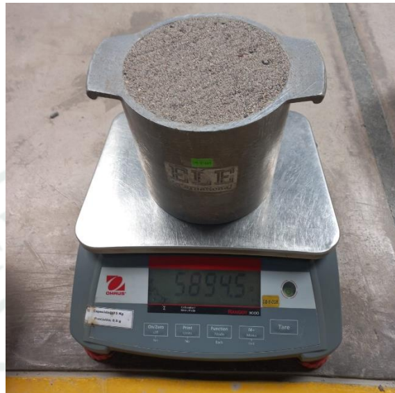
Figura 99 Pesaje para ensayo peso unitario de agregado fino.
