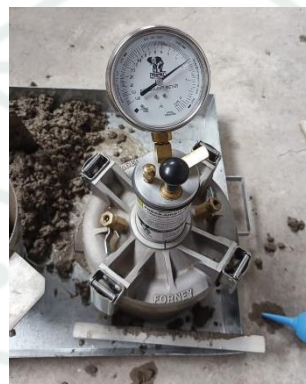
Figura 39 Resultado de 2.1% de aire atrapado en la mezcla
