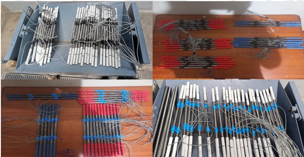
Figura 119 Aceros habilitados sujetos a cables antes del vaciado
