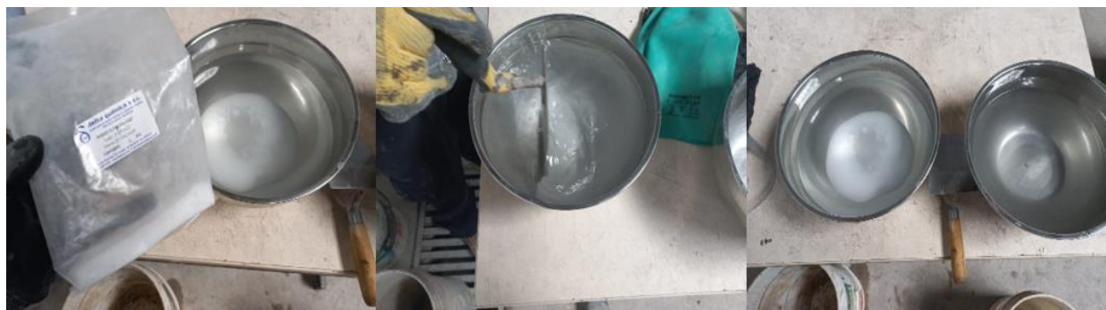
Figura 126 Disolución de cloruro de sodio en el agua de amasado para inducir la corrosión
