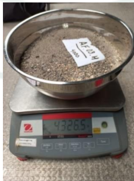
Figura 23 Muestra de agregado fino después de 24 horas al horno a 110°C
