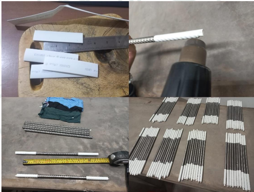
Figura 115 Preparación de acero, colocación de manga termo retráctil
