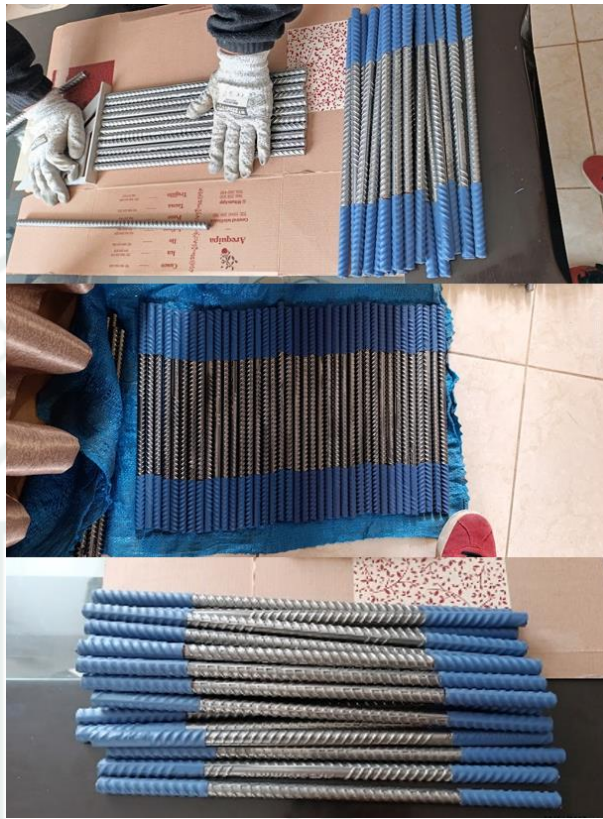
Figura 116 Colocación de manga termo retráctil
