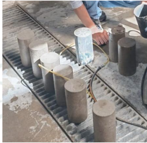
Figura 46 Detalle de probetas cilíndricas de concreto
