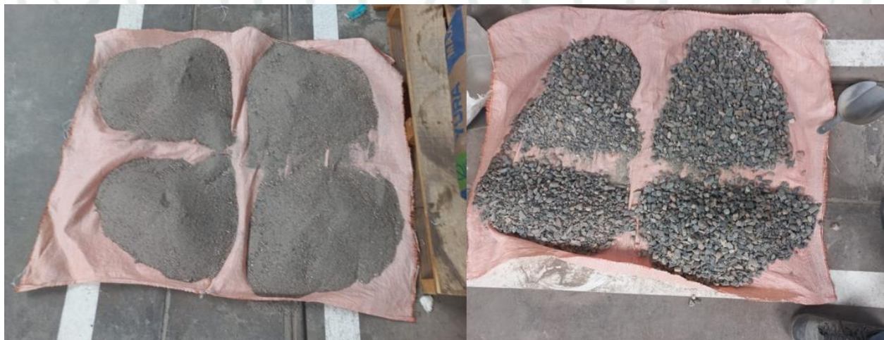
Figura 94 Cuarteo de agregado fino y agregado grueso
