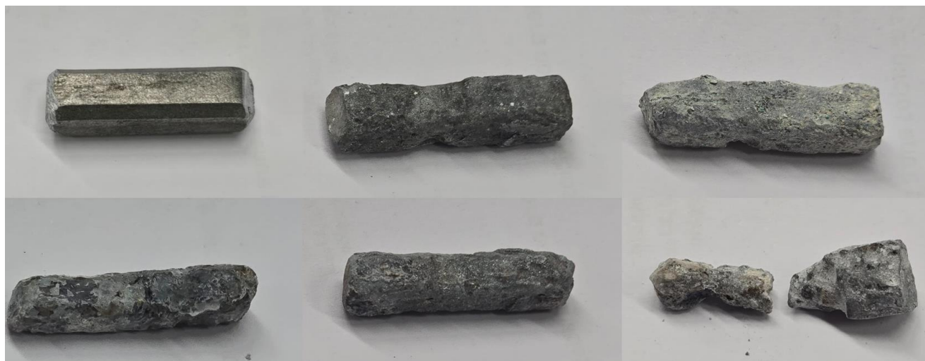
Figura 152 Corrosión y consumo del ánodo durante el tiempo
