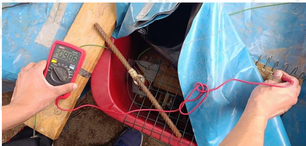
Figura 81 Medición del potencial electroquímico de despolarización tras un periodo de 24 horas
