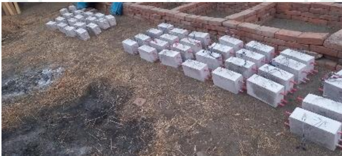
Figura 137 Emplazamiento de especímenes prismáticos a entorno de estudio para la determinación de velocidad de corrosión y potencial eléctrico
