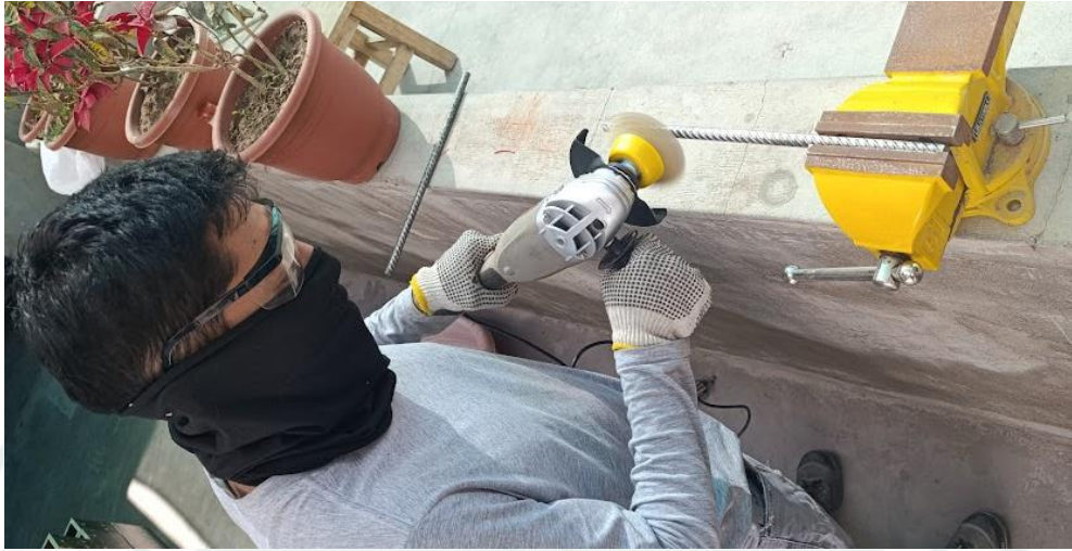
Figura 114 Lijado de los aceros corrugados
