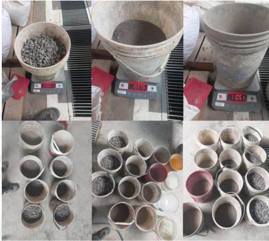
Figura 124 Pesaje de agregados y cemento según diseño de mezcla
