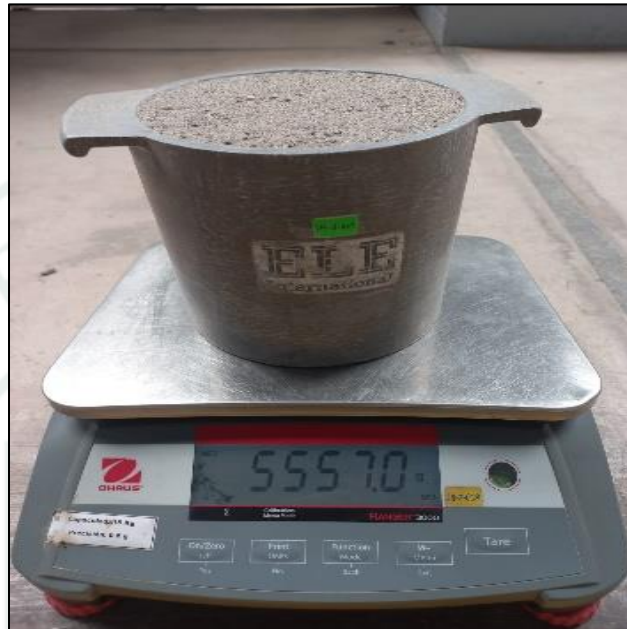
Figura 28 Peso suelto N°2 del agregado fino + recipiente
