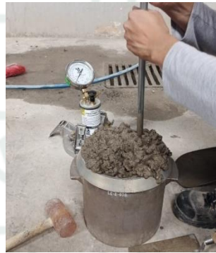
Figura 39 Resultado de 2.1% de aire atrapado en la mezcla
