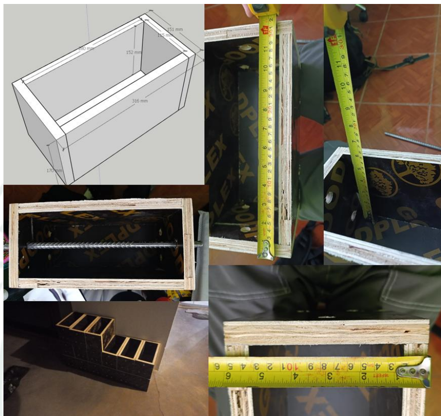
Figura 120 Elaboración de encofrados para probetas prismáticas
