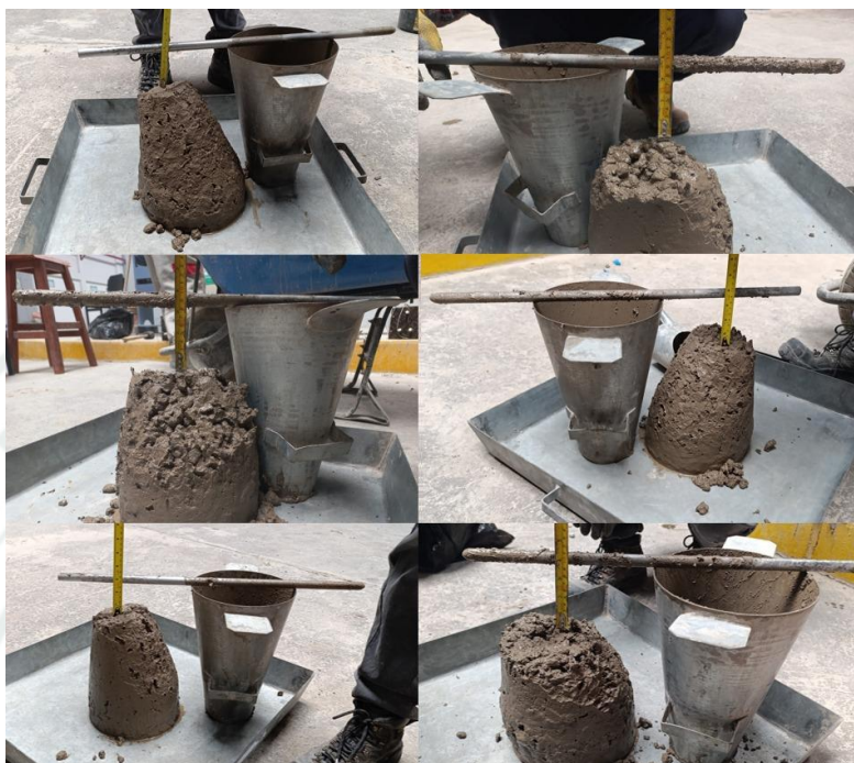
Figura 128 Medición del asentamiento del concreto fresco mediante el cono de Abrams
