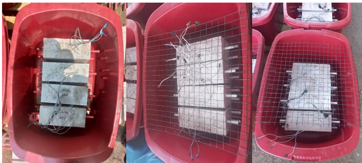
Figura 140 Disposición ordenada y trazado de los conductores eléctricos sobre la malla de referencia
