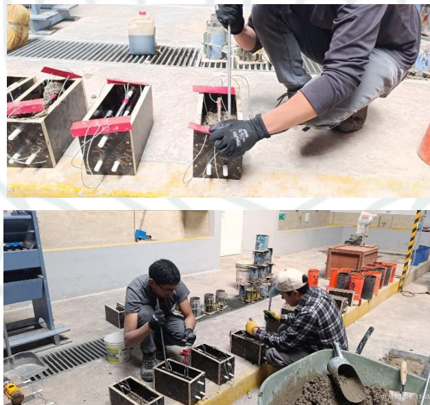
Figura 59 Vaciado de probetas y proceso de compactación
