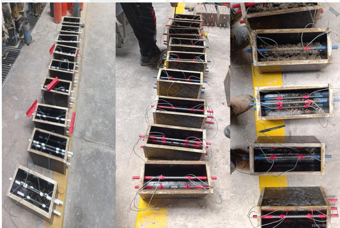
Figura 123 Liberación de encofrado y distribución de cables y acero para vaciado de probetas prismáticas
