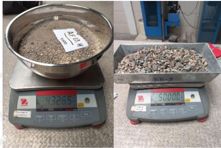
Figura 95 Muestreo de agregado fino y grueso para ensayos de contenido de humedad y granulometría después de estar 24 horas en el horno.
