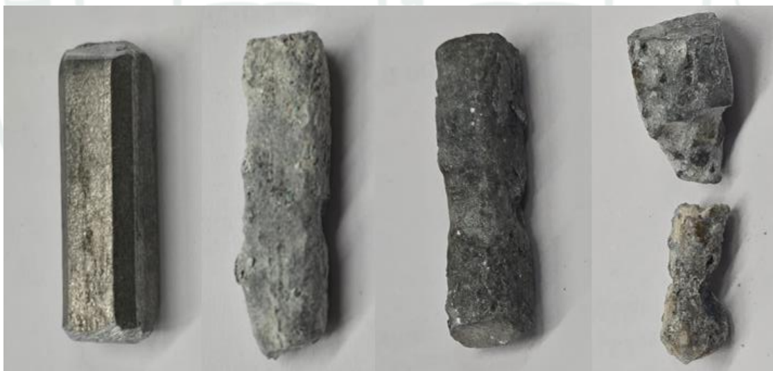
Figura 88 Consumo y evolución de la corrosión en ánodos de sacrificio Zinc
