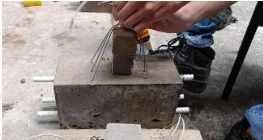
Figura 134 Acondicionamiento de los especímenes y terminales eléctricos previo al curado por inmersión
