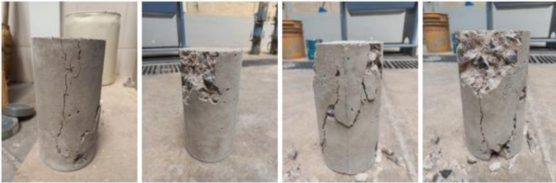
Figura 51 Fallas en probetas cilíndricas de concreto sometidas a ensayo de compresión
