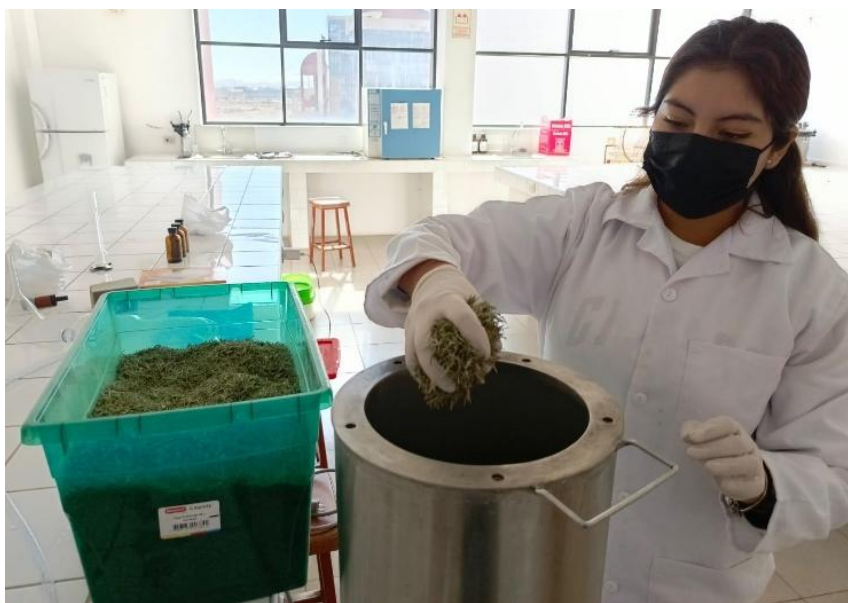
Figura 18. Llenado del equipo de destilación por arrastre de vapor con la muestra Rosmarinus Officinalis L.
