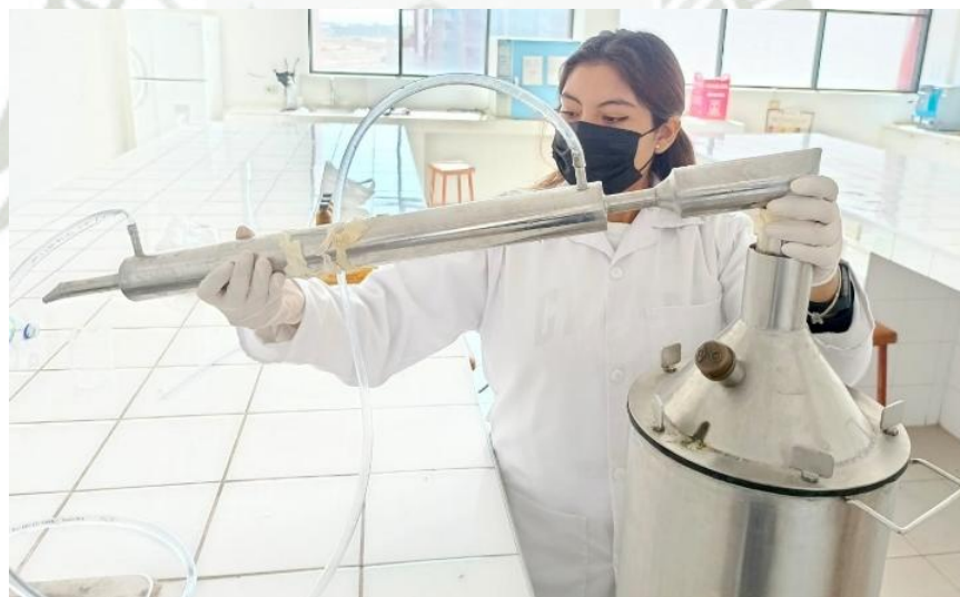
Figura 19. Instalación del equipo de destilación por arrastre de vapor
