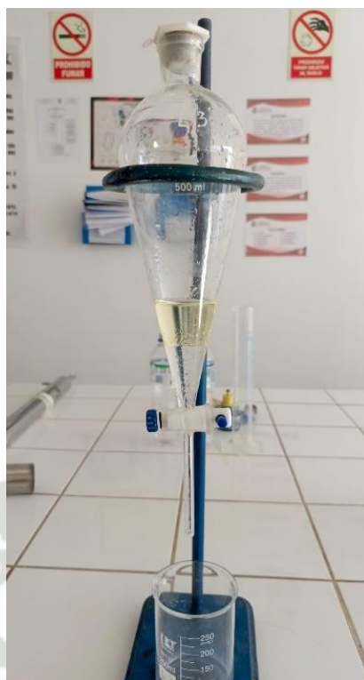
Figura 24. Separación de fases: Hidrolato y AEs de Rosmarinus Officinalis L. en pera de decantación
