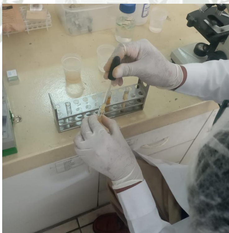
Decantación de líquido del tubo de ensayo dejando el sedimento
