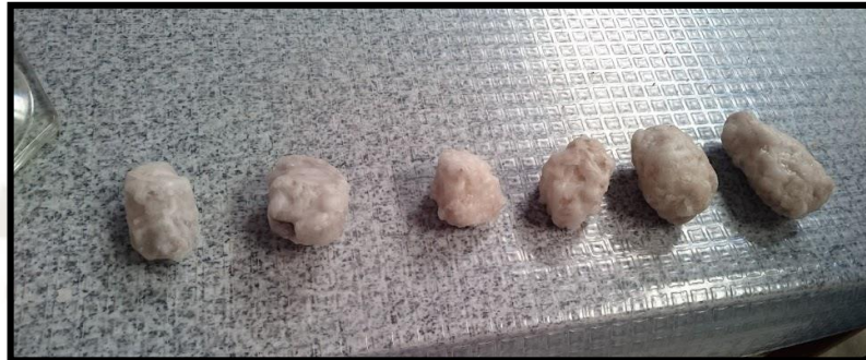
Ilustración 29 Muestras inalteradas con parafina. (Fuente: Elaboración propia)
