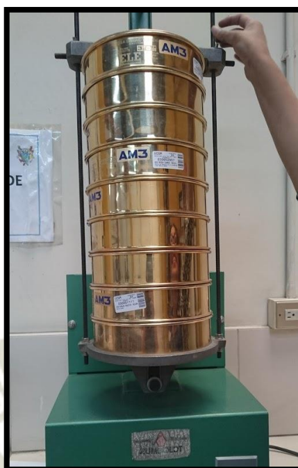
Ilustración 27 Proceso de tamizado. (Fuente: Elaboración propia)
