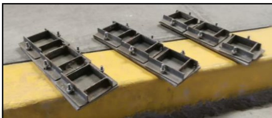
Ilustración 22 Moldes para concreto del tamaño de la caja de corte.
