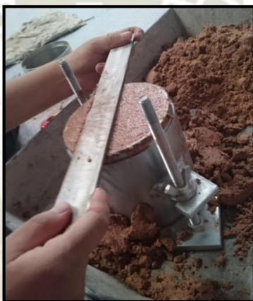
Ilustración 31 Enrazado del molde para el ensayo de compactación. Fuente: Elaboración propia
