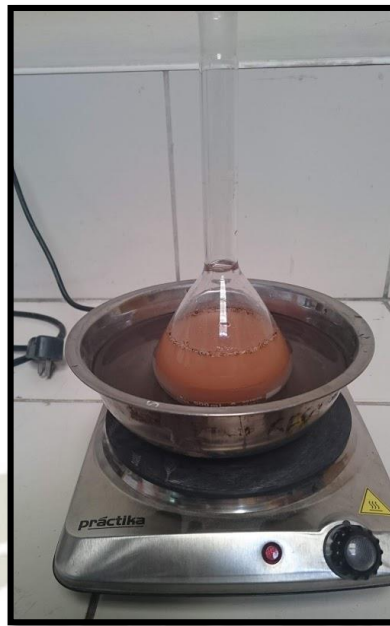
Ilustración 30 Ensayo de gravedad específica. Fuente: Elaboración propia
