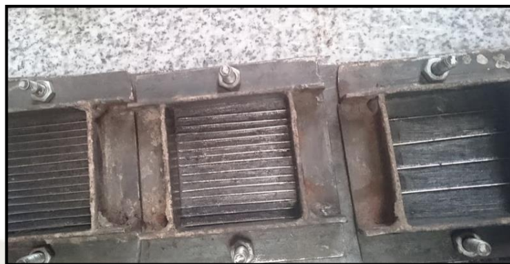
Ilustración 26 Aguja colocadas a diferentes distancias en los molde.
