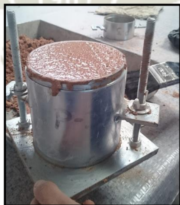
Ilustración 32 Ensayo de compactación Fuente: Elaboración propia
